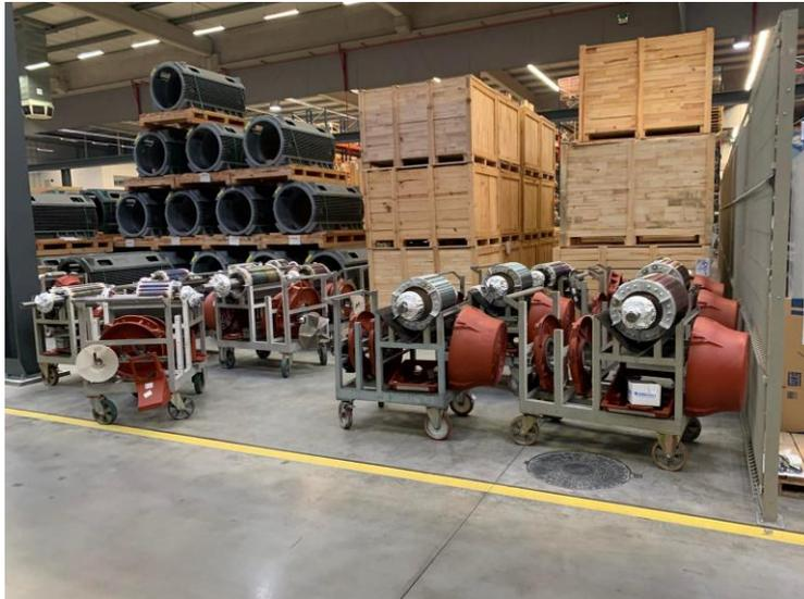
Figura 37 - Excesso de *stock* de carrinhos *kit junjo* junto à linha de montagem.
