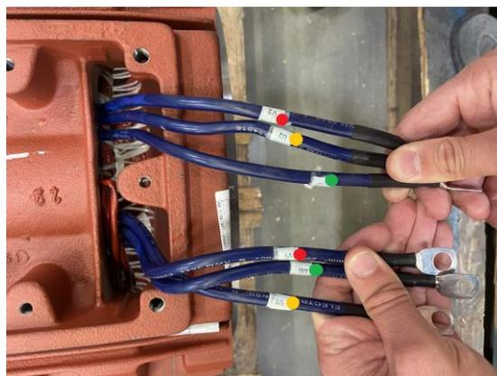
Figura 53 - Aplicação de um sistema de cores nos cabos de potência.
