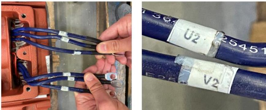
Figura 42 - Etiquetas dos cabos de potência.
