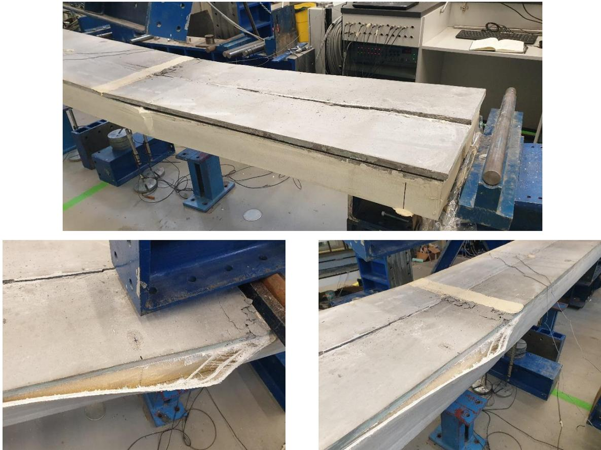
**Figura 55.** Modo de rotura do painel PPR\_2.
