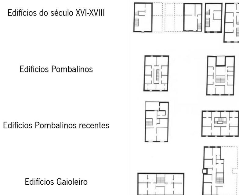
**Figura 4.** Layout de planta típica para os diferentes tipos de edifícios antigos em Lisboa [3].
