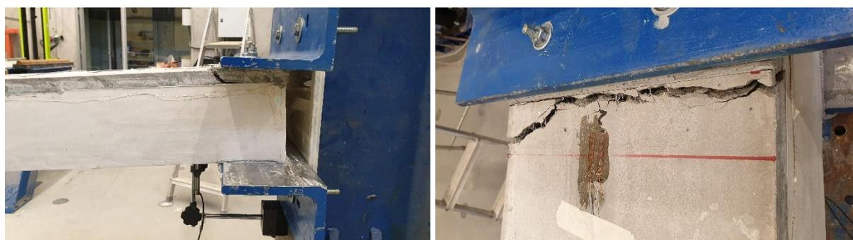
**Figura 100.** Painel LT-2LA\_2 - fissuração do FRC junto da cantoneira.
