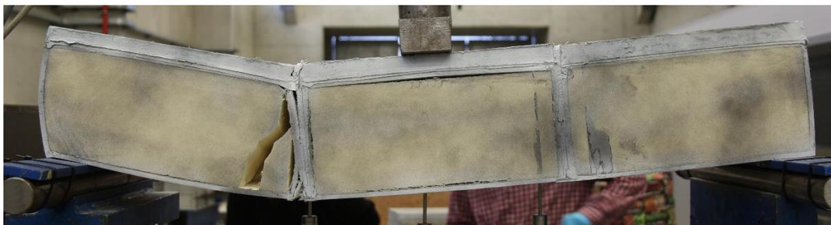
**Figura 80.** Modo de rotura provete 3PP\_02.
