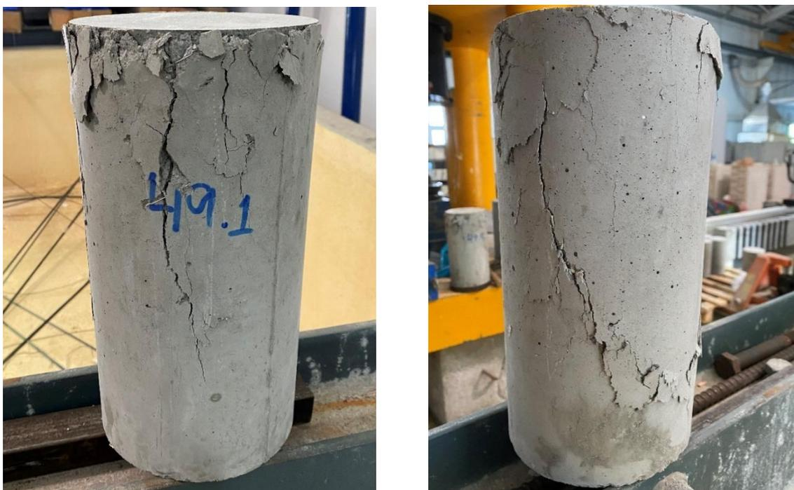
**Figura 17.** Apresentação da rotura de um provete da amassadura M1.
