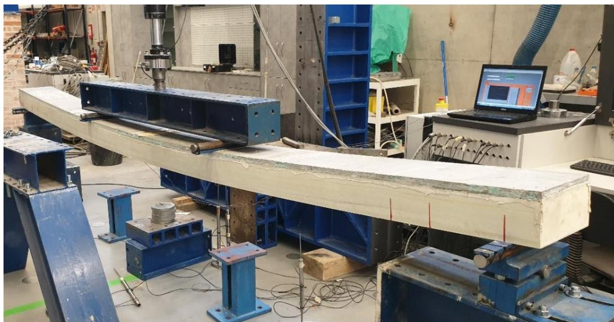
**Figura 46.** Deformação do painel PR\_1 durante o ensaio (na iminência da rotura).
