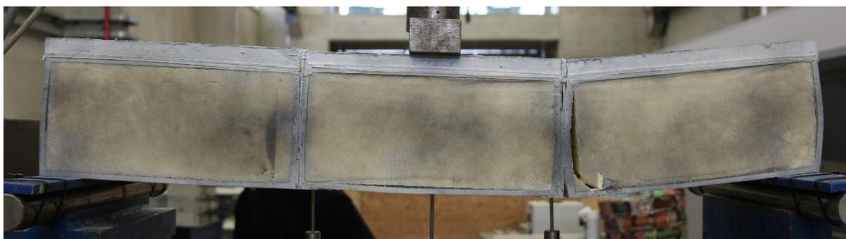
**Figura 81.** Modo de rotura provete 3PP\_03.
