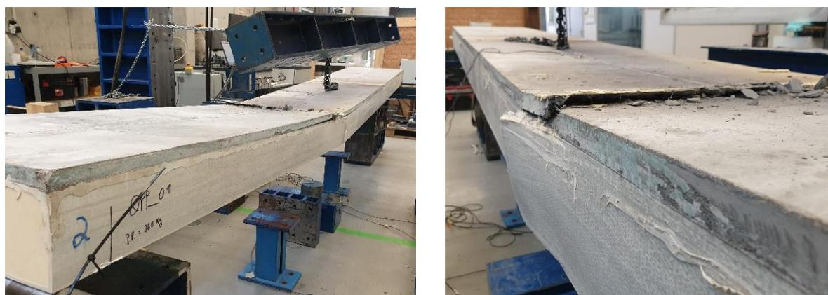
**Figura 54.** Modo de rotura do painel PPR\_1.
