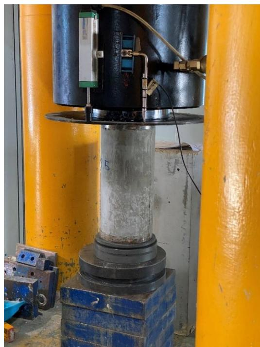
**Figura 15.** Ensaio de compressão do FRC.
