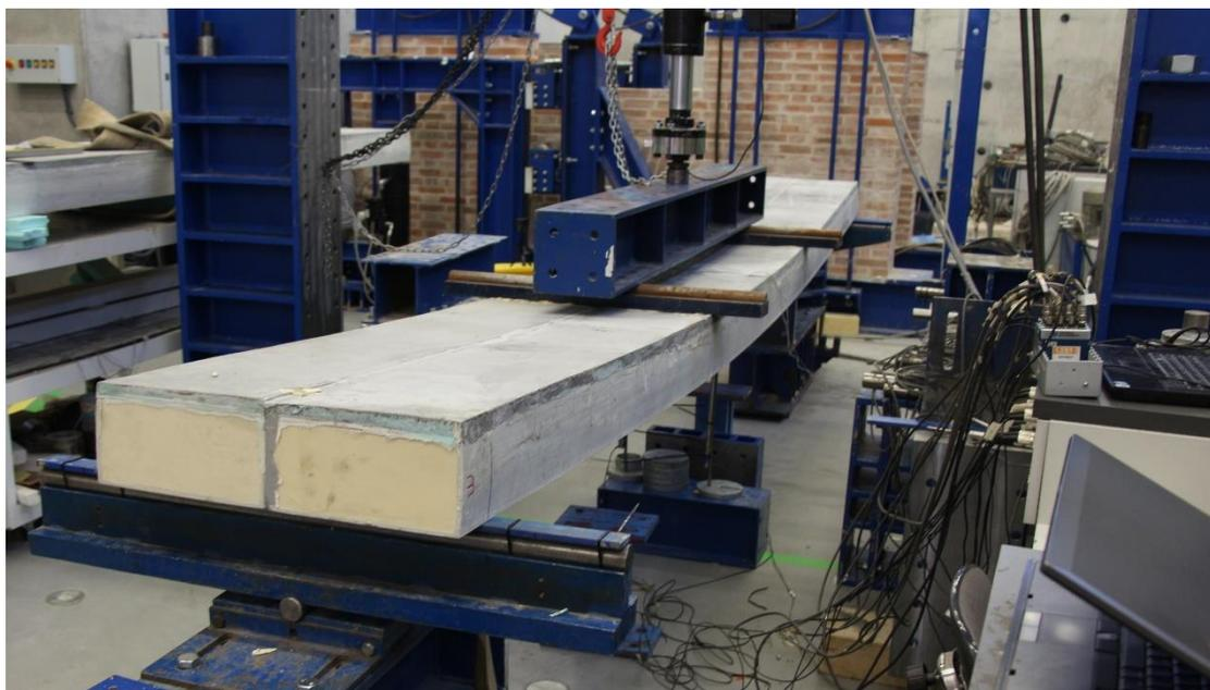
**Figura 51.** Deformação do painel PPR\_1 durante o ensaio.
