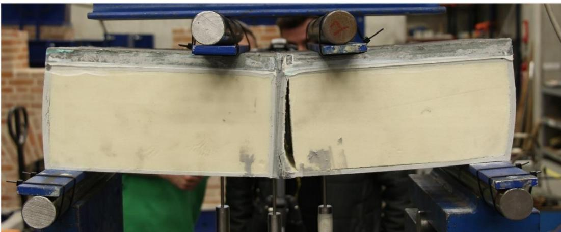
**Figura 77.** Modo de rotura provete 2PP\_03.
