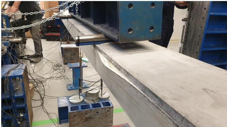
**Figura 88.** Modo de rotura do painel LT-1L\_2.
