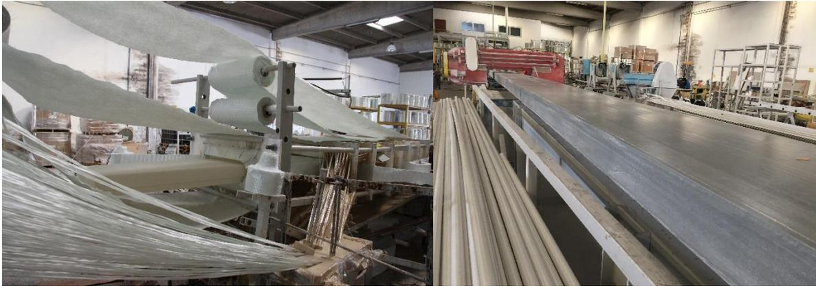
**Figura 36.** Processo de pultrusão do painel EasyFloor.
