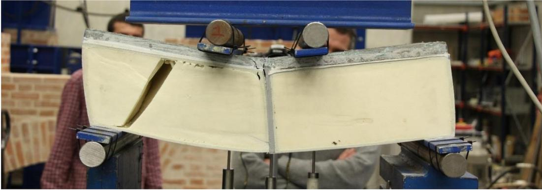
**Figura 75.** Modo de rotura provete 2PP\_01.
