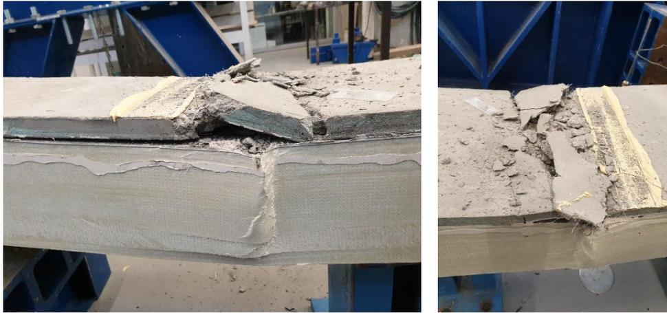
**Figura 48.** Modo de rotura do Pannel PR\_2.
