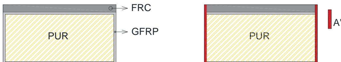
**Figura 42.** Secção transversal do painel.
