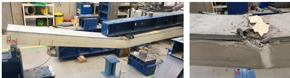
**Figura 47.** Modo de rotura do Painel PR\_1.
