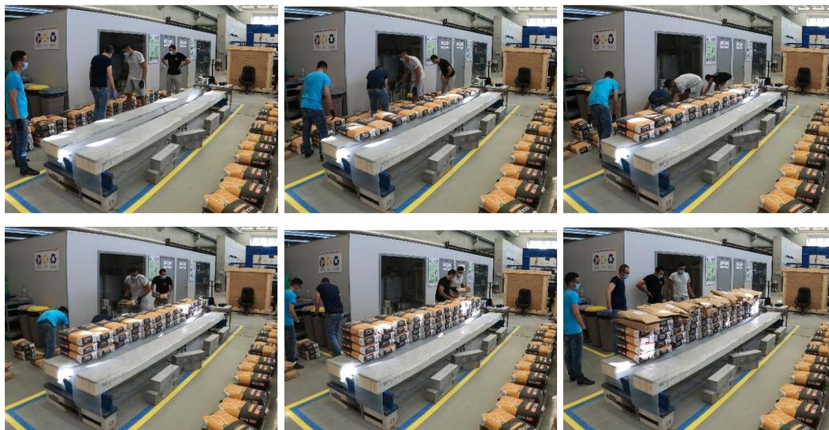
**Figura 111.** Processo de aplicação da carga – Painel P4\_F2.
