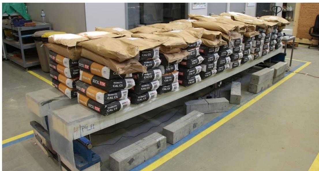
**Figura 112.** Painéis sob o efeito de uma carga constante no tempo.
