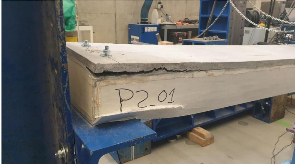
**Figura 87.** Modo de rotura do painel LT-1L\_1.
