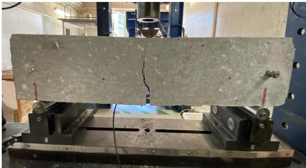
**Figura 22.** Proвете prismáticos após o ensaio de flexão.
