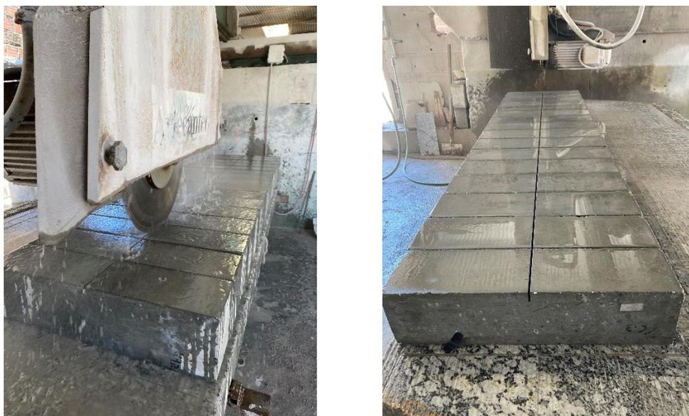
**Figura 18.** Realização do entalhe nos provetes prismáticos.
