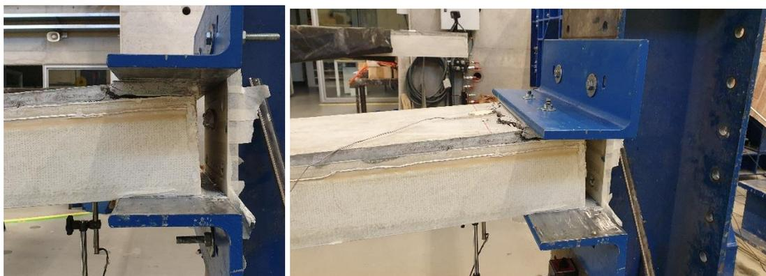
**Figura 99.** Painel LT-2LA\_1 - fissuração do FRC junto da cantoneira
