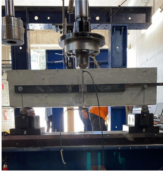
**Figura 19.** Ensaio de flexão em três pontos de carga.
