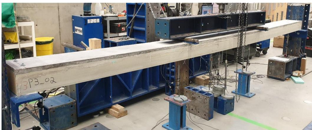
**Figura 71.** Fotografia da configuração da ligação tipo LT-1L.
