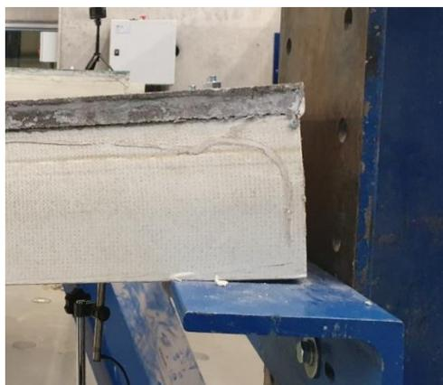
**Figura 85.** Painel LT-1L\_1 – danos observados junto à ligação painel - parede.
