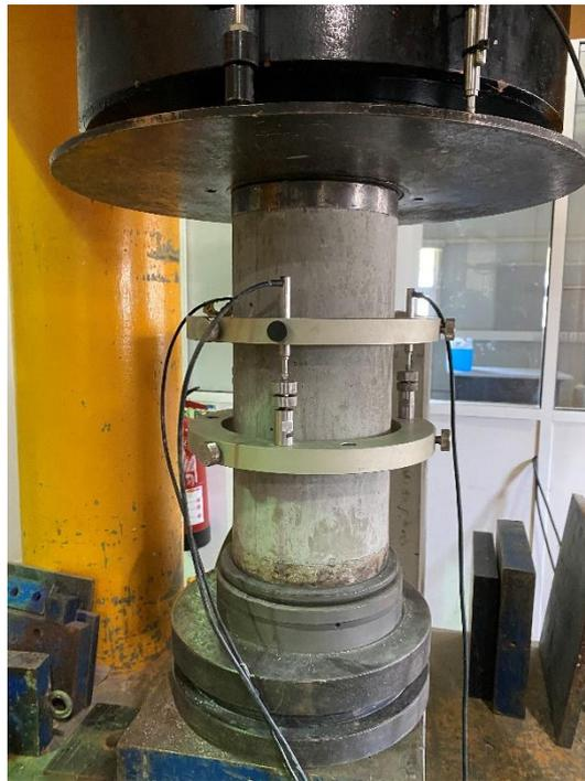
**Figura 16.** Ensaio cíclico em compressão para a avaliação do módulo de elasticidade do FRC.
