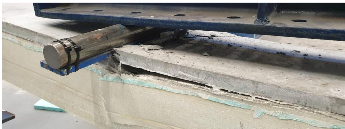
**Figura 101.** Modo de rotura do painel LT-2LA\_1.
