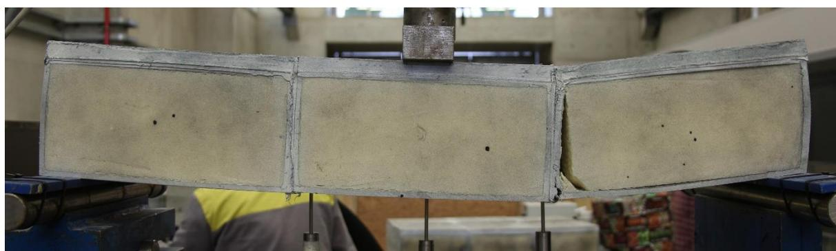
**Figura 79.** Modo de rotura provete 3PP\_01.
