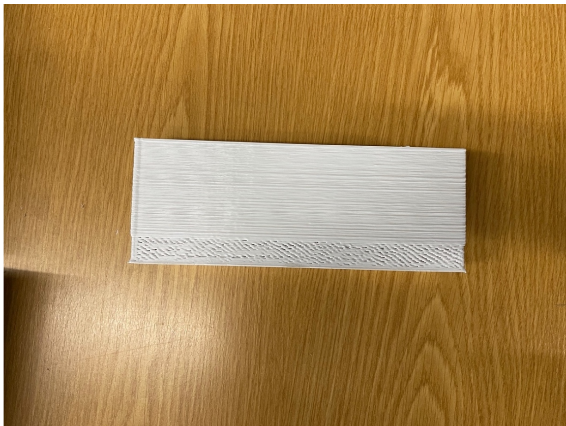
Figura 25. Amostra de peça prestes a ser ensaiada à flexão.
