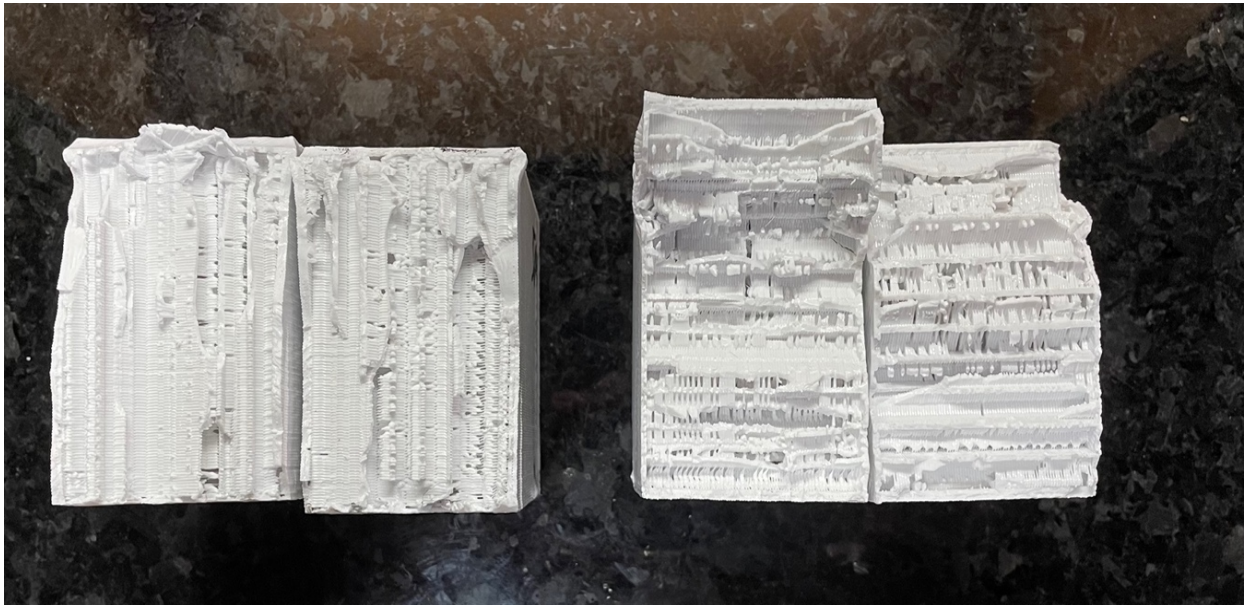
Figura 29. Pormenor da orientação de impressão, na geometria Stars com 50% de infill .
