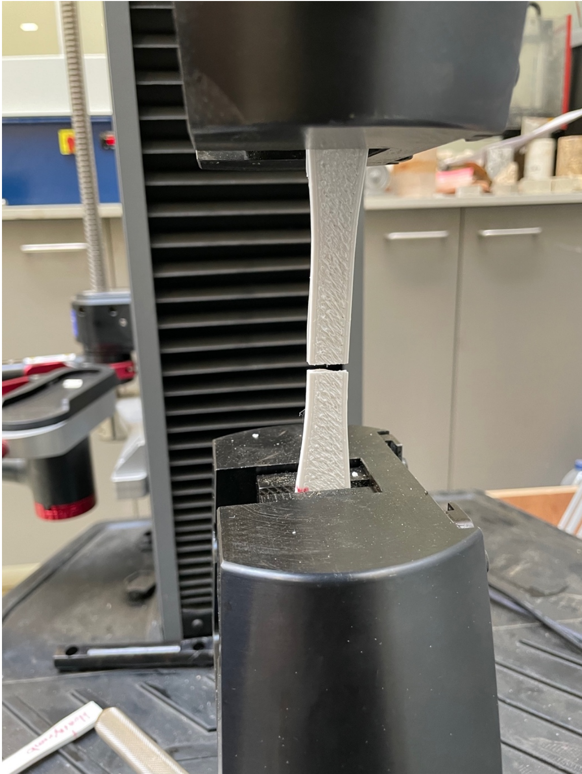
Figura 20. Resultado de um ensaio à tração.
