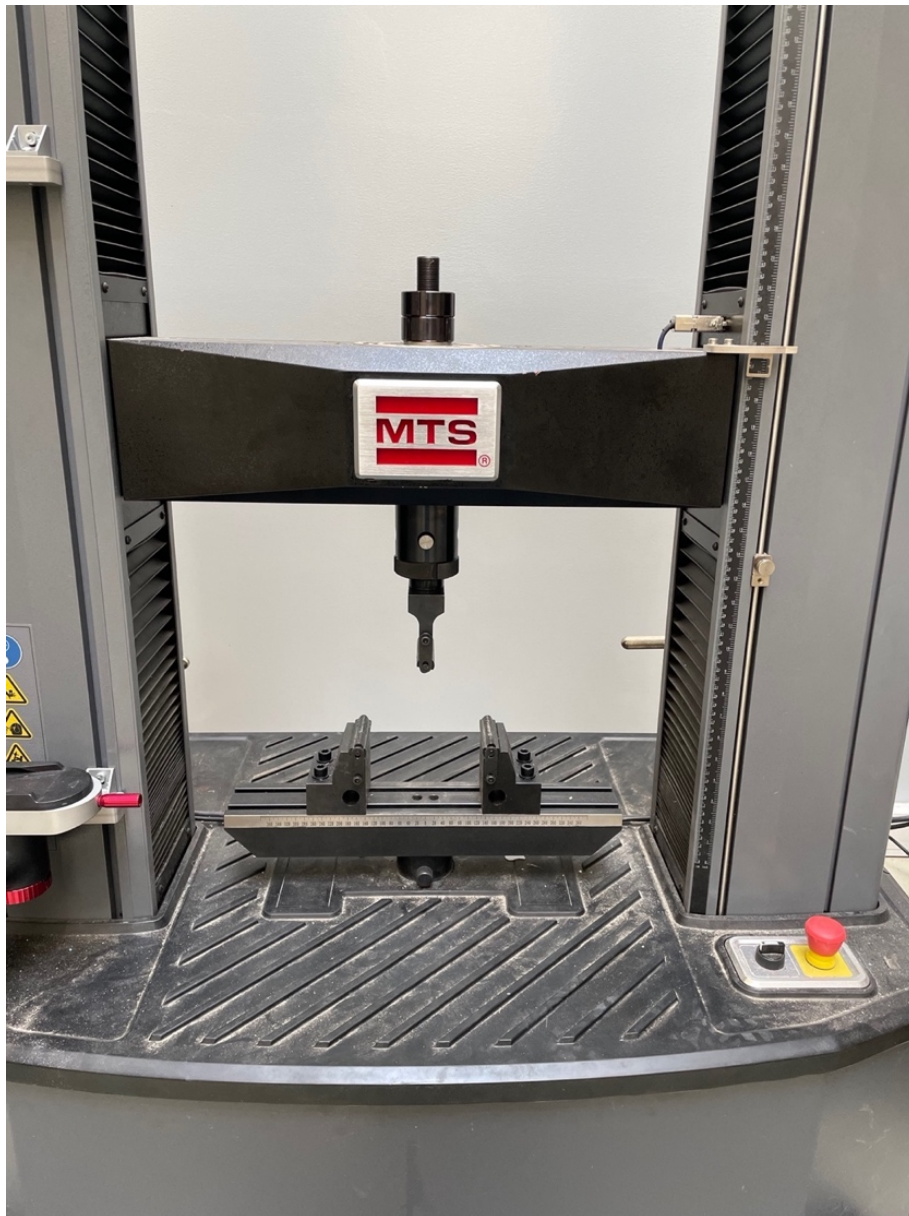
Figura 26. Equipamento para a realização dos ensaios de flexão.
