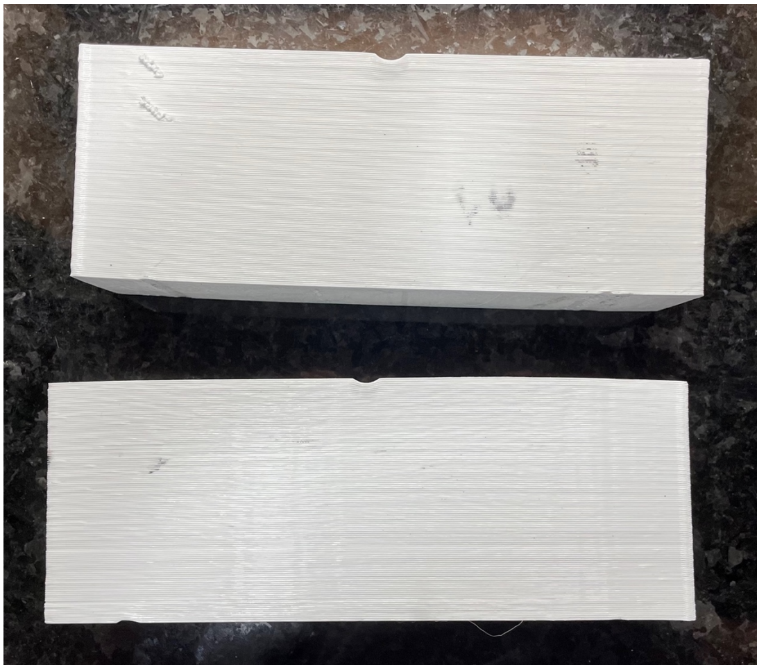
Figura 37. Exemplos com 75% de infill após teste à flexão.
