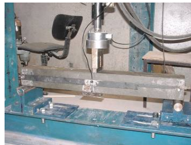
c) Resistência à tracção por flexão e energia de fractura do betão
