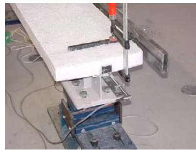
a) Medição de deformação vertical ao longo da viga b) Medição do deslizamento relativo entre secções de aço e de betão, junto aos apoios
