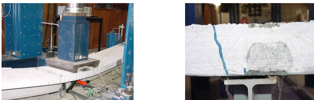
Figura 9 – Viga VM8 em fase de rotura
