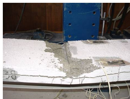
Figura 8 – Viga VM7 em fase de rotura
