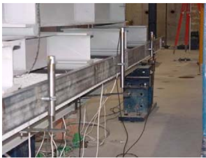
a) Medição de deformação vertical ao longo da viga b) Medição do deslizamento relativo entre secções de aço e de betão, junto aos apoios
