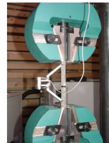
d) Resistência à tracção do aço
