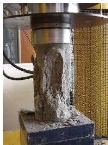
a) Resistência à compressão do betão
