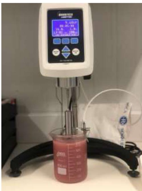
Figura 11 - Equipamento utilizado na determinação da viscosidade.
