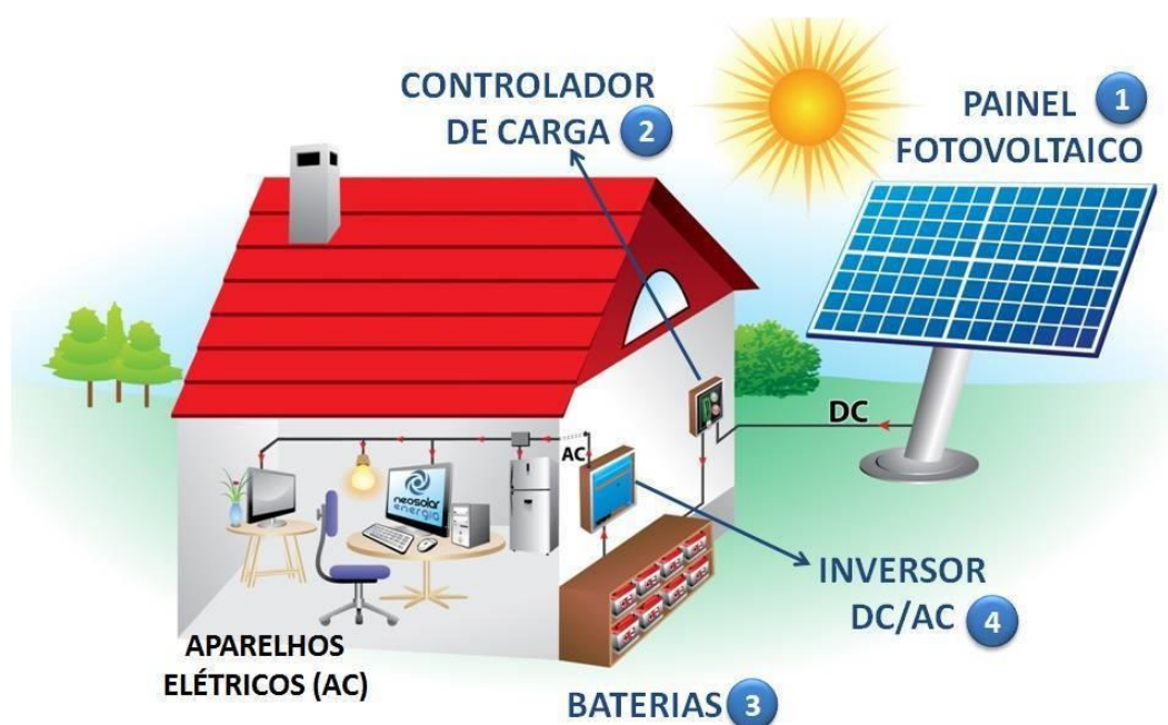
Figura 6.1 - Representação esquemática de um sistema fotovoltaico autónomo típico [61]
