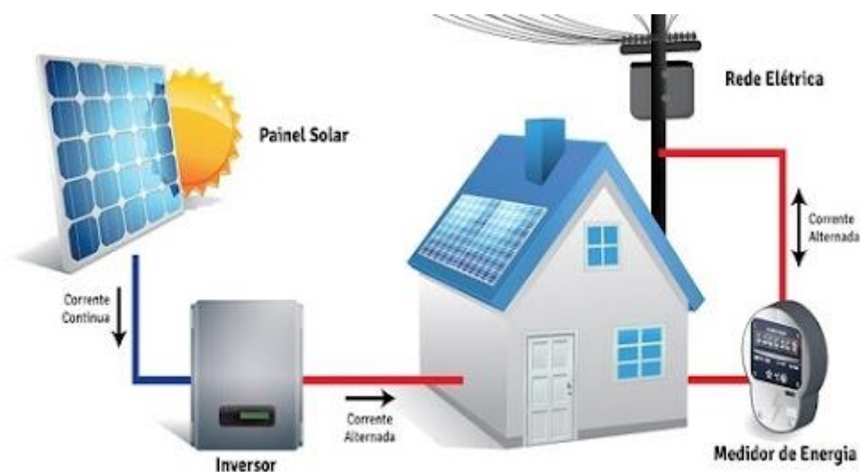
Figura 6.1 - Representação esquemática de um sistema on grid típico [61]
