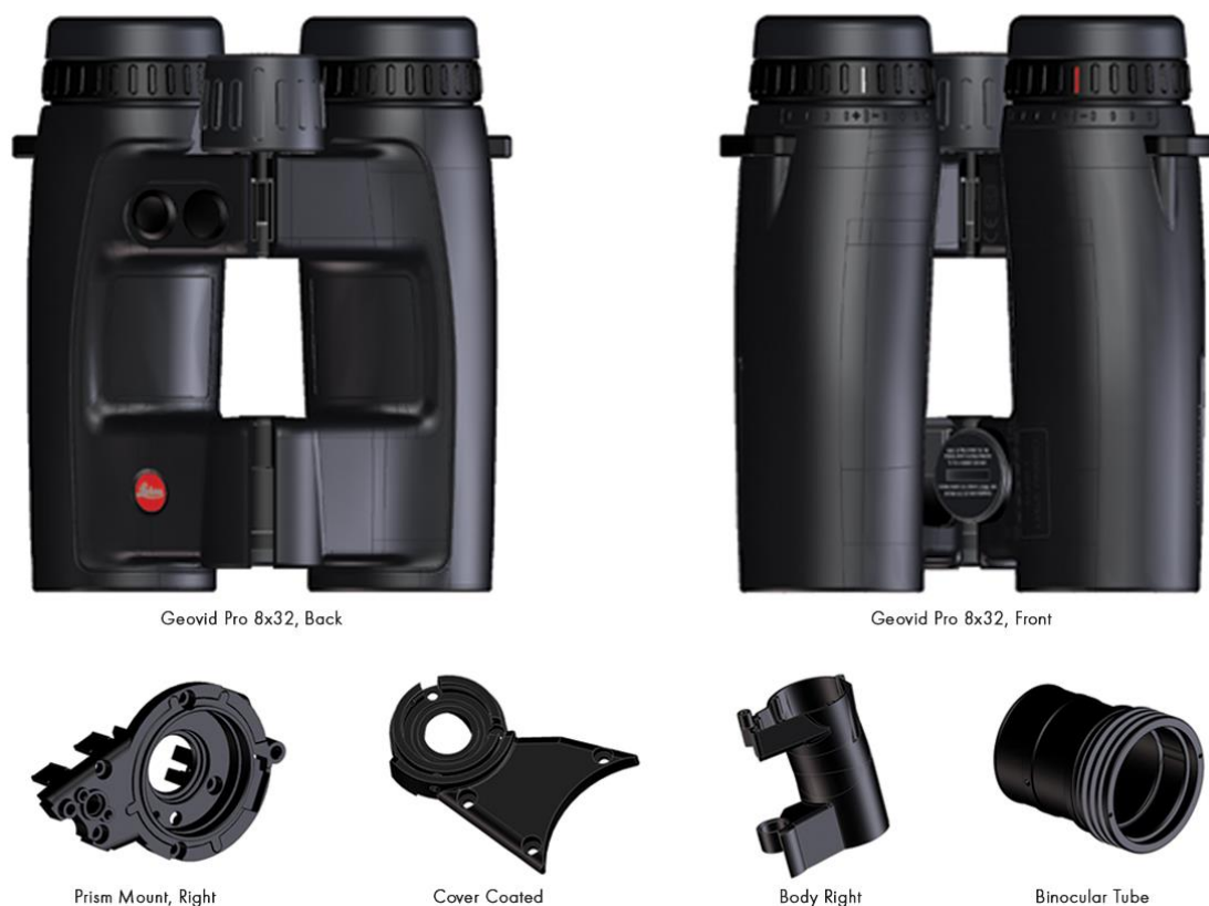
Figura 18 - Desenho de engenharia (modelo 3D) - Geovid Pro 8x32
