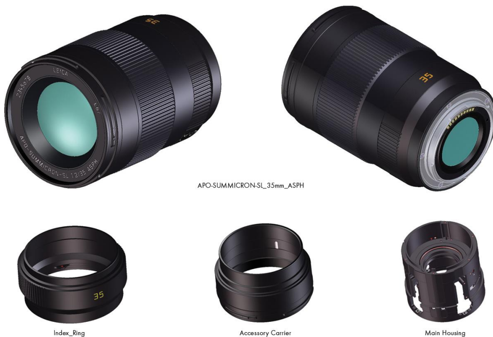
Figura 17 - Desenho de engenharia (modelo 3D) - APO-Summicron-SL 35 f/2 ASPH
