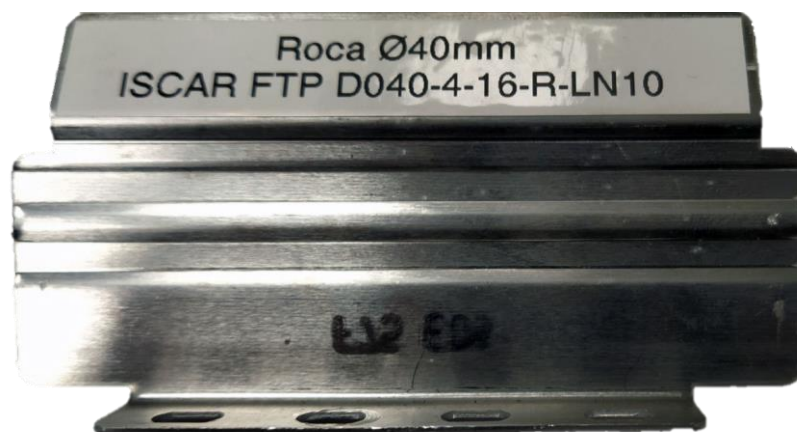
Figura 34 – Separador utilizado nas gavetas modulares devidamente etiquetado.
