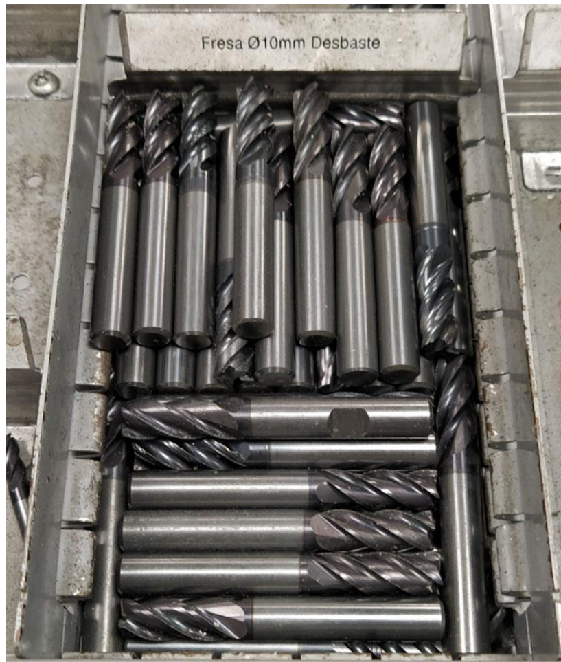
Figura 26 – Acondicionamento das ferramentas de corte.
