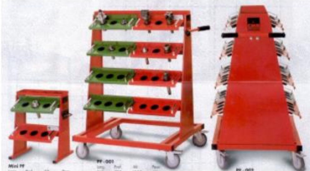
Figura 18 – Armários de transporte de ferramentas no chão-de-fábrica [12].
