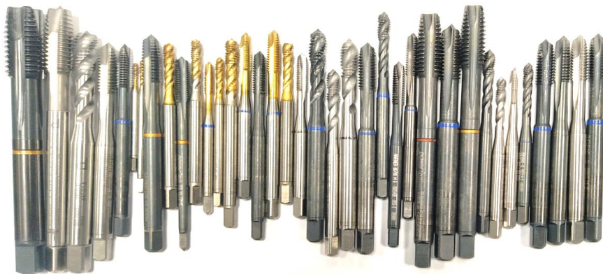
Figura 30 – Ferramentas de rosca em bom estado que estavam armazenadas nas bancadas de trabalho.
