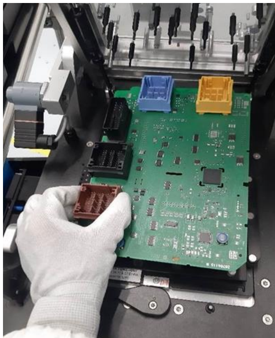
Figura 50: Incorreto manuseamento das placas.
