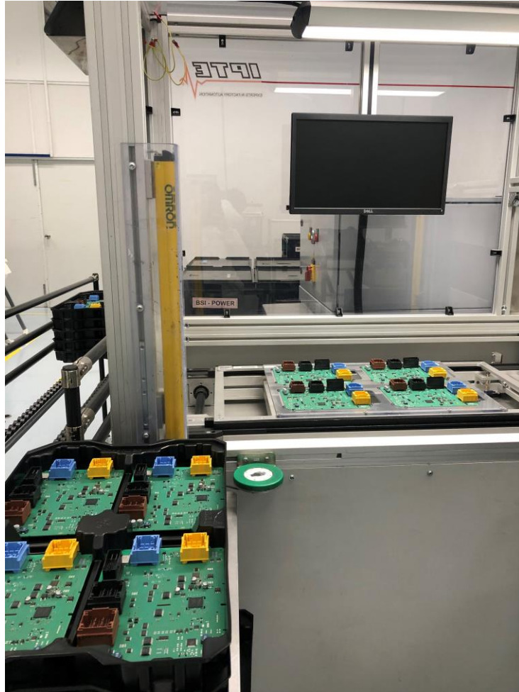
Figura 67: Aproximação da rampa à máquina.
