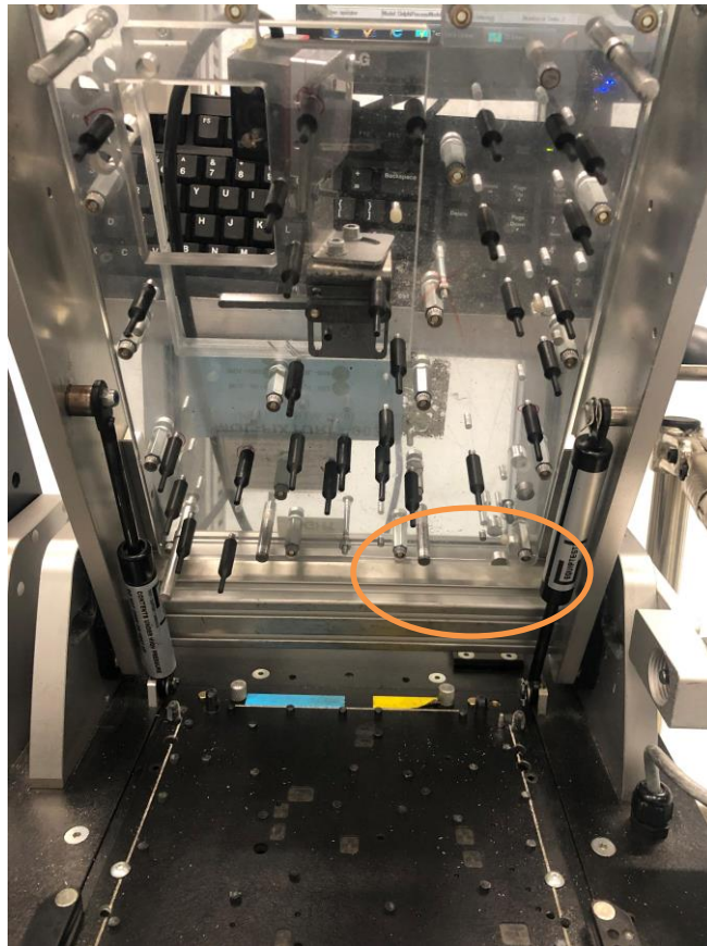
Figura 66: Remoção dos pinos superiores.
