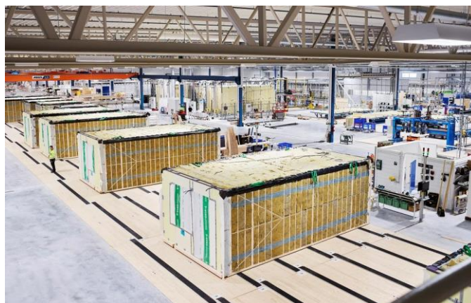
Figura 37 - Sistema de movimentação dos módulos na linha de montagem
