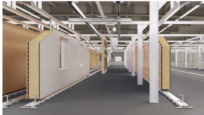
Figura 38 - Trilhos para acabamento e armazenamento de painéis
