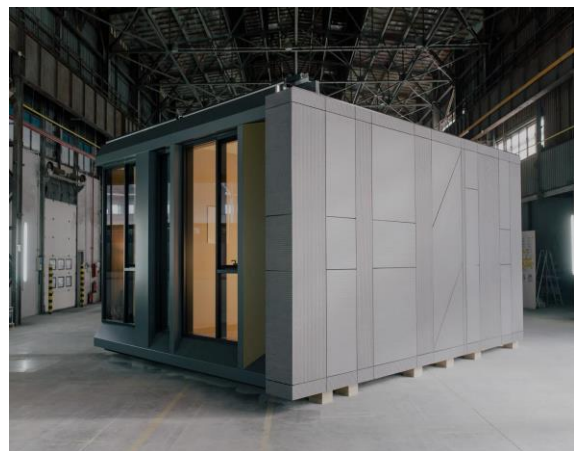
Figura 25 - Módulo utilizado na edificação do hotel AC Hotel New York NoMad
