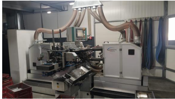
Figura 26 - Representação de uma das máquinas de lixar talheres, disposta numa cabine
