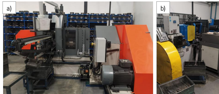
Figura 21 - Laminadores lateral (a) e Laminadores longitudinal (b)
