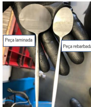
Figura 15 - Exemplos representativos de uma peça laminada e uma peça rebarbada
