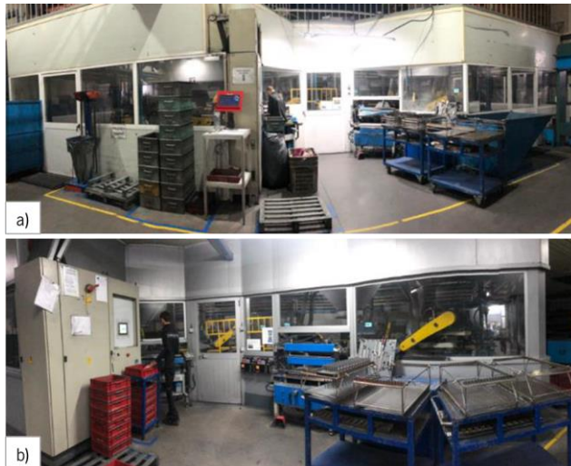
Figura 29 - Máquina de polir garfos (a) e máquina de polir colheres (b) dispostas nos pavilhões 1 e 2, respetivamente
