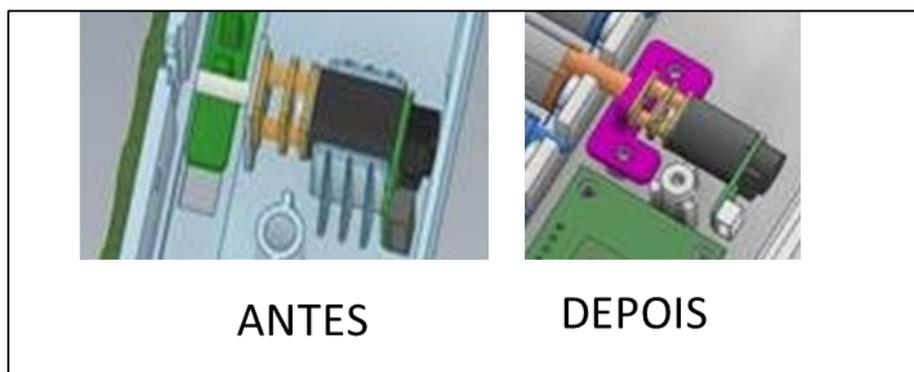
**Figura 24** - Suporte do motor – Antes e Depois
