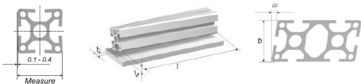
Figure 22 -Perfil da estrutura
