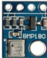
Figura 35: Módulo de sensor de pressão (BMP180)
