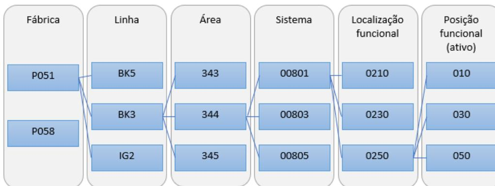
Figura 15 - Hierarquia do sistema de codificação usado nas várias fábricas da empresa
