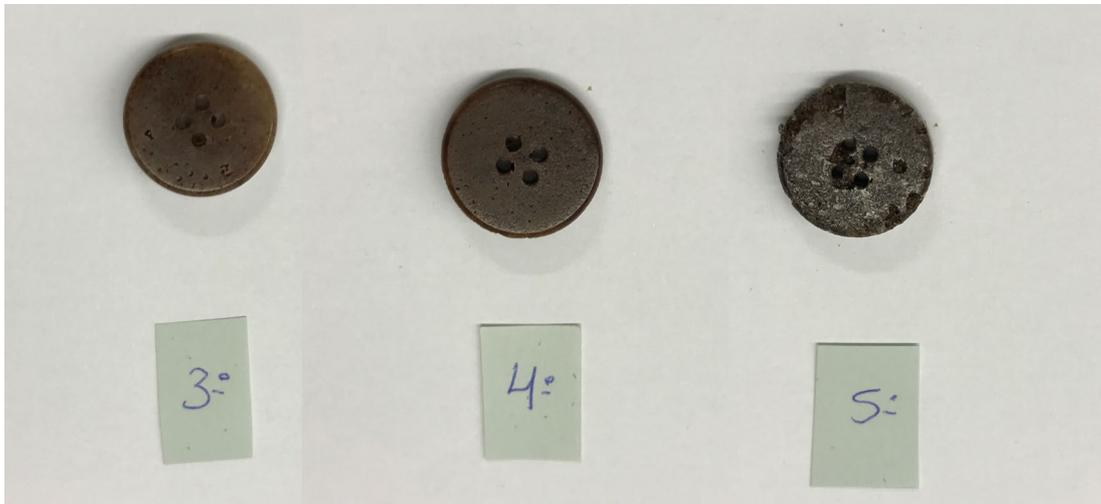
Figura 69: Amostras Aprovadas no Teste de Durabilidade NP EN ISO 6330:2002.
