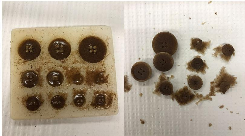
Figura 65: Resultado do Processo de Testagem em Recipiente Cerâmico e Molde de Silicone.
