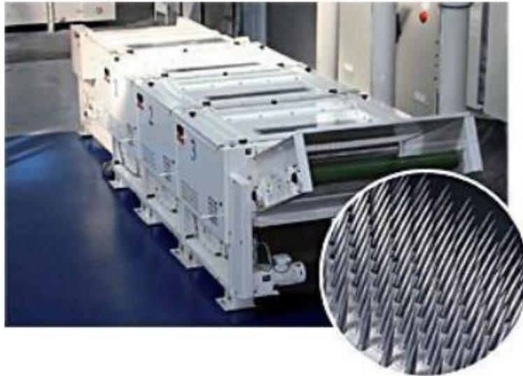
Figura 17. Exemplo de desfibradeira de 3 estágios projetada para reciclagem de sobras de fiação.
