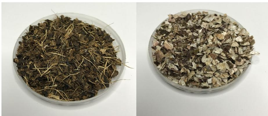
Figura 54: Resultado do Processo de Trituração de Resíduos (com o moinho do CVR)
