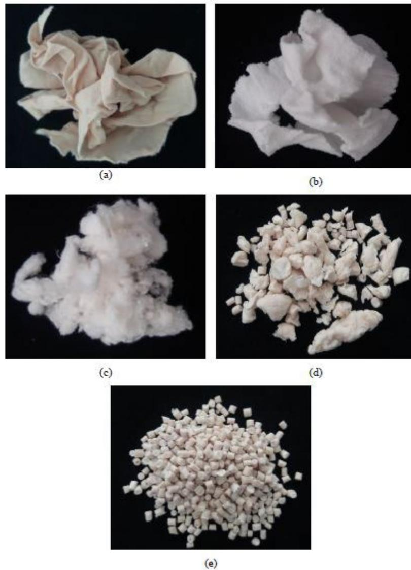
Figuras 22. Estágios da transformação dos resíduos de poliamida em flocos: (a) retalho de tecido 98% poliamida e 2% elastano; (b) retalho de poliamida alvejado; (c) retalho de poliamida livre de elastano; (d) poliamida ao atingir seu ponto de fusão e (e) chips de poliamida
