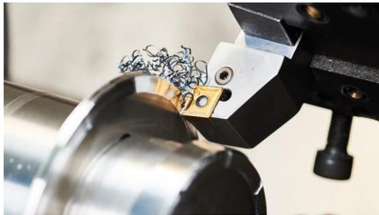
Figura 2.1 - Processo de remoção de material por torneamento.
