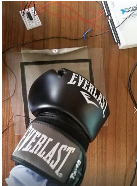
Figura 43-Sensor piezoresistivo com a área de uma luva de boxe
