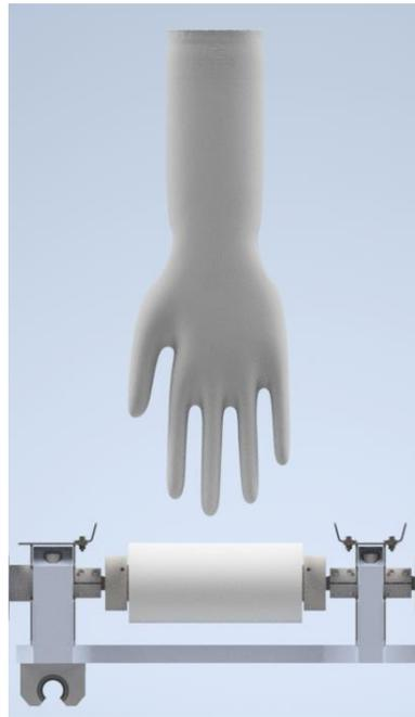
*Figura 4.27 - Posicionamento do molde antes de iniciar a limpeza*
