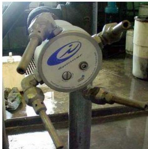
*Figura 2.17 - Sistema de jatos rotativos. Retirado de [13]*
