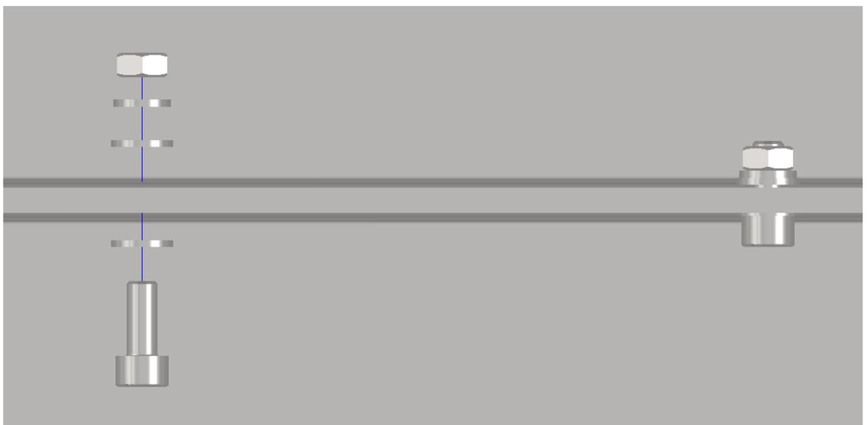
*Figura 4.12 - Componentes para fazer a ligação entre as extremidades das chapas centrais*
