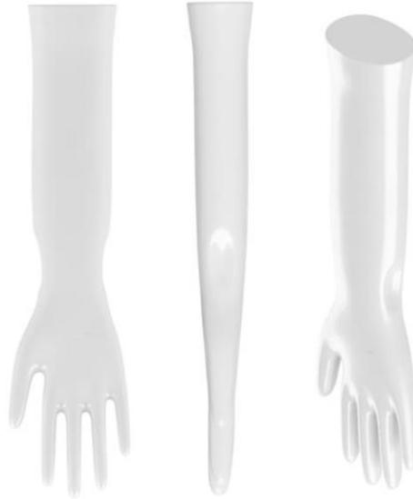
*Figura 3.1 - Formato do molde cerâmico*
