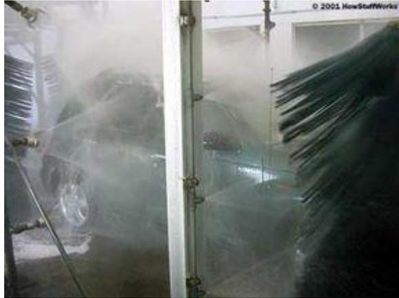
*Figura 2.18 - Arco de enxaguamento. Retirado de [13]*
