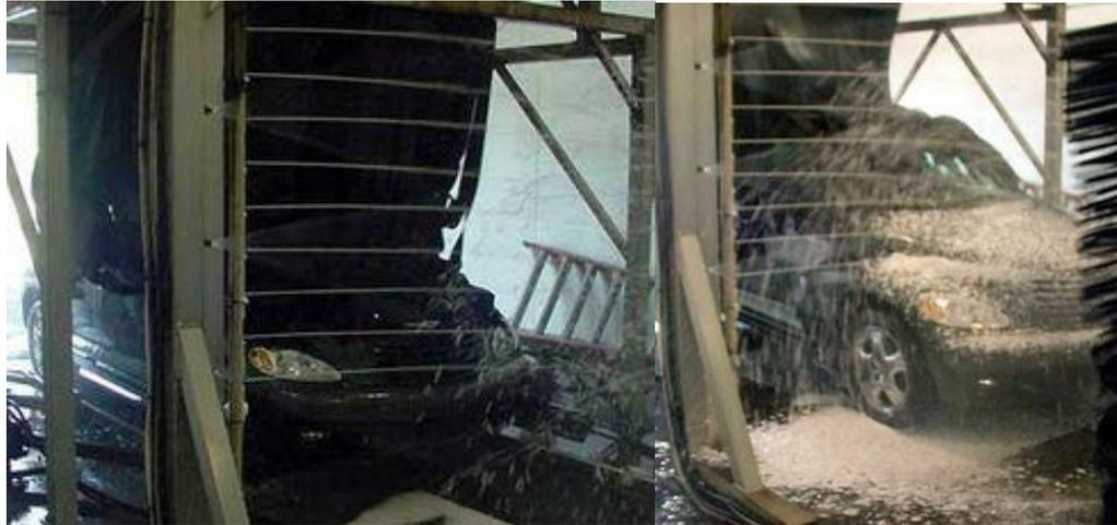
*Figura 2.15 - Pré-molho (esquerda) e aplicador de espuma (direita). Retirado de [13]*
