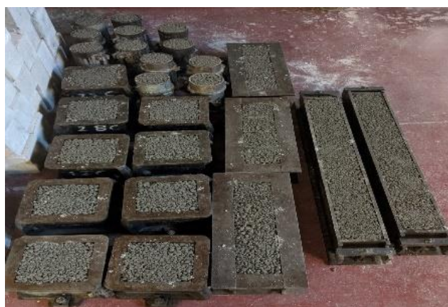
Figura 2: Aspetto dos provetes do ensaio confeccionados para relações de 0,35 W/C e 40 vibrações em segundos
