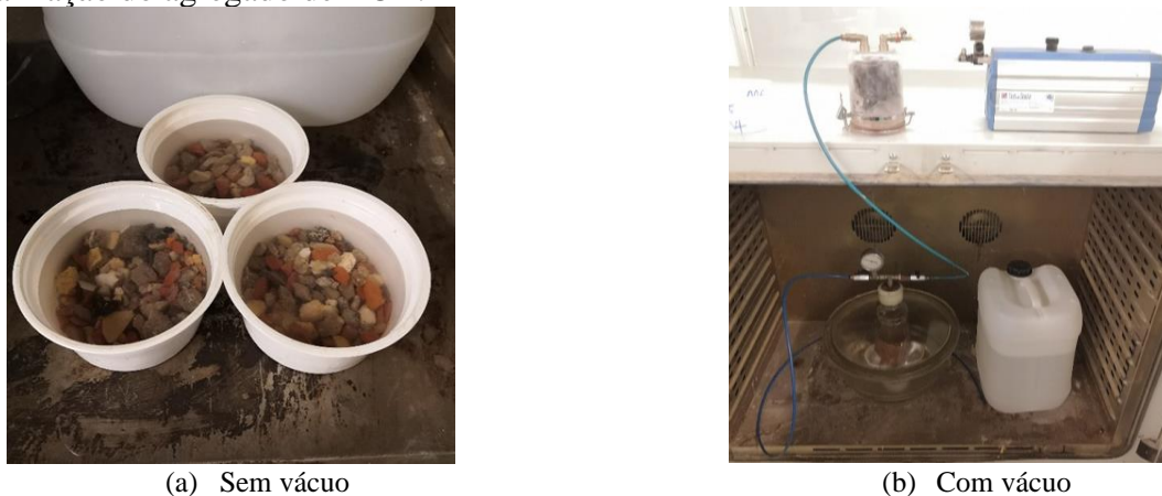
Figura 3: Absorção de PCM-PP pelo RCD.
