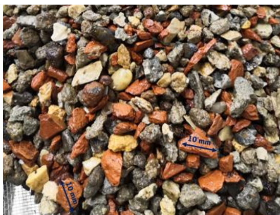
Figura 5: RCD aditivado com PP (RCD-PP) com vácuo durante 4 horas.
