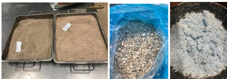
Figura 1: Materiais reutilizados – a) agregado reciclado de construção; b) concha de ostra; c) máscara
