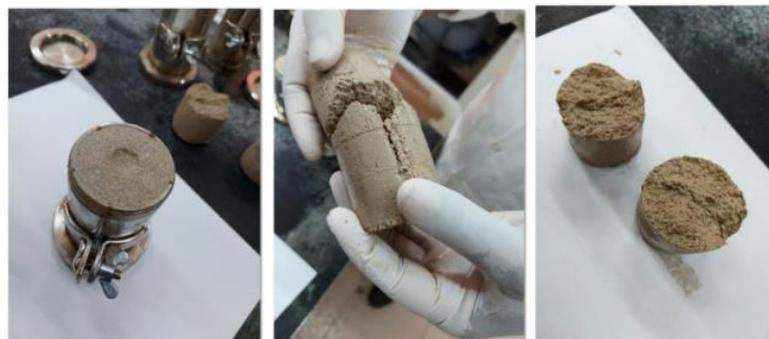
Figura 4: Mistura BSF desenformada após 24 horas de cura
