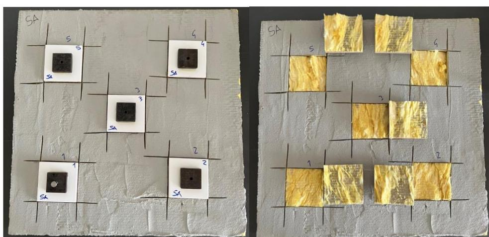
Figura 3: Preparação dos provetes de análise por aplicação da solução aquosa com e sem agente molhante, e tipologias de rotura dos ensaios de aderência
