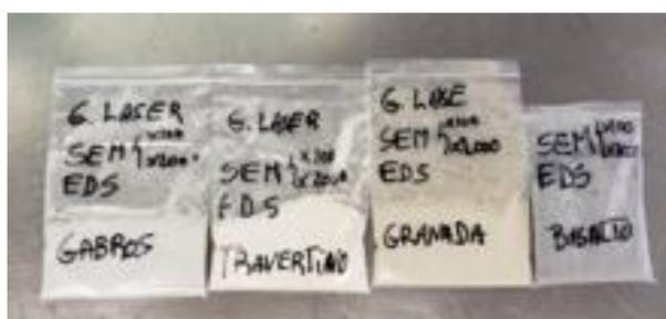
Figura 1: Lamas após a secagem (pó de rocha)
