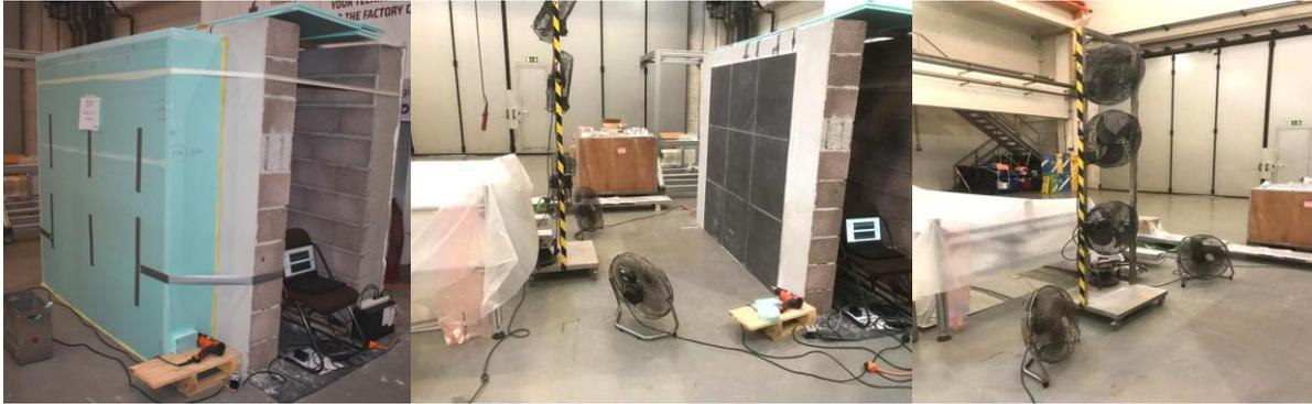
Figura 5: Sistemas de aquecimento (esquerda) e arrefecimento (centro e direita) usados para as duas amostras
