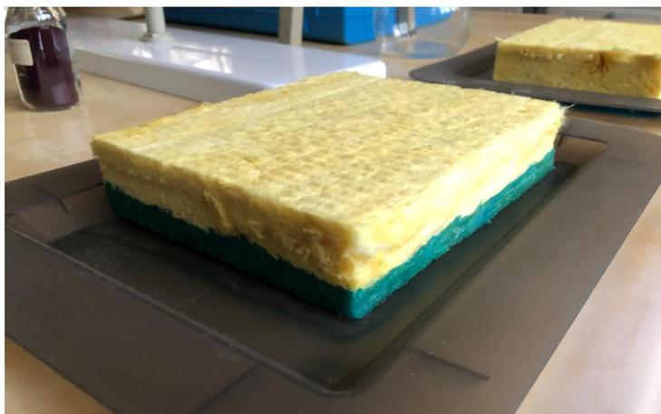
Figura 4: A mistura de água com 0.1% de agente molhante resulta em absorção de água rápida e níveis elevados, que resultará num material que perde hidrofobicidade e durabilidade
