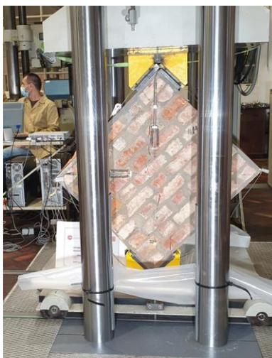
Figura 5: Modelo não reforçado montado na prensa para ensaio de compressão diagonal
