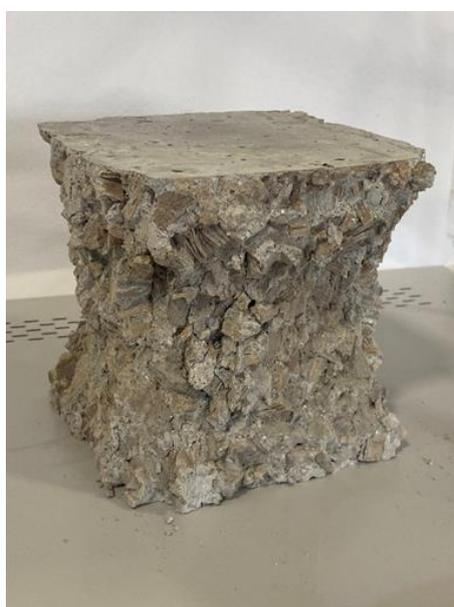
Figura 5: Modo de rotura à compressão
