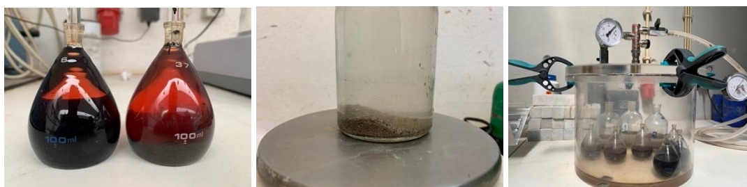
Figura 1: Determinação das massas volúmicas, da Cinza Volante de Biomassa, Cinza de Fundo de Biomassa e Cinza de Cascas de arroz.
