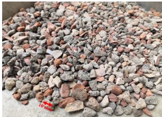
Figura 1: Resíduos de construção e demolição (RCD).
