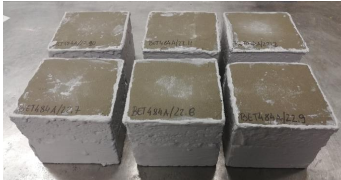
Figura 2: Provetes para ensaio de determinação da capacidade de impermeabilização após revestimento da base e das faces laterais.
