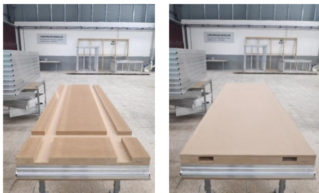
Figura 4: Exemplo de integração de negativos no painel.
