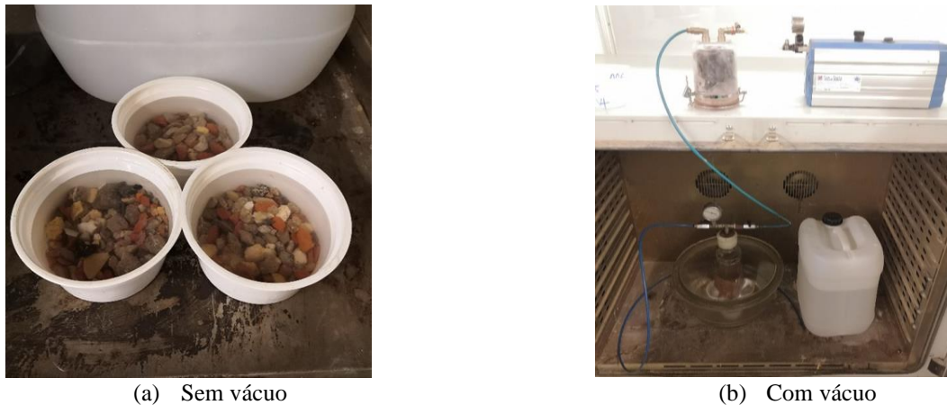
Figura 3: Absorção de PCM-PP pelo RCD.
