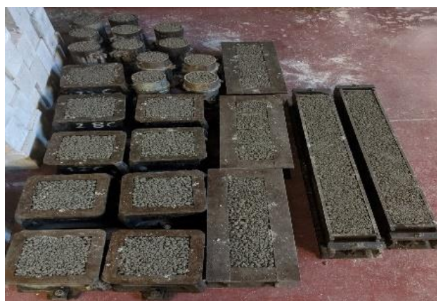
Figura 2: Aspetto dos provetes do ensaio confeccionados para relações de 0,35 W/C e 40 vibrações em segundos
