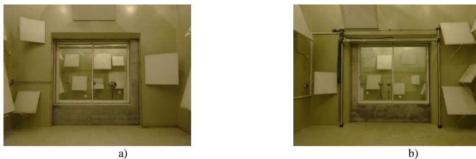
Figura 2: Instalação da janela dentro das câmaras acústicas: a) vista da câmara emissora; b) vista da câmara recetora.
