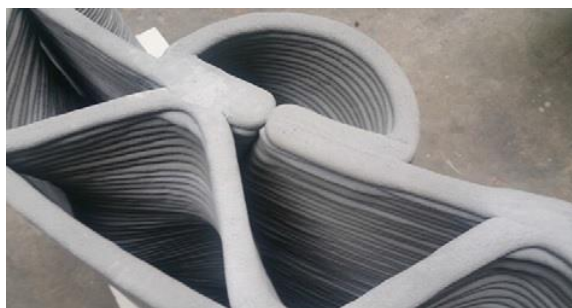
Figura 1: Complexidade da trama interna de uma parede impressa. Fonte: Gosselin et al., 2016.
