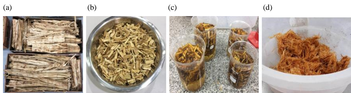
Figura 3: Processos para obtenção da fibra: (a) bagaço seco, (b) bagaço cortado, (c) bagaço antes da inserção em ácido, (d) e fibras vegetais após secas em estufa
