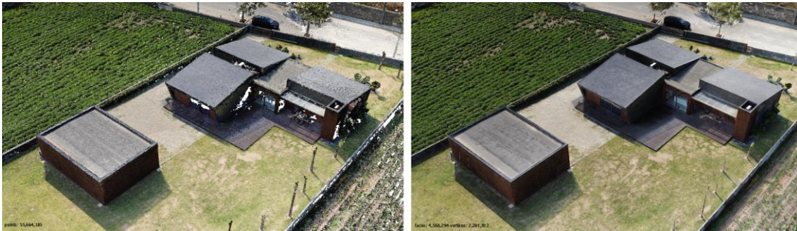
Figura 3: Reconstrução fotogramétrica do edifício em estudo, fachada Norte. À esquerda, a sua nuvem de pontos, e à direita, a sua mesh 3D.
