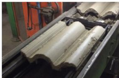
Figura 10: Resultado estético: (a) comparação tonalidade, telha esquerda comum e da direita com inserção de fibras, (b) defeito no perfil acarretado pelas fibras
