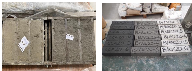
Figura 2: Amassadura das séries e desmoldagem dos provetes.
