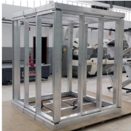
Figura 2: Estrutura metálica base do sistema modular construtivo da CONCEXCEC.
