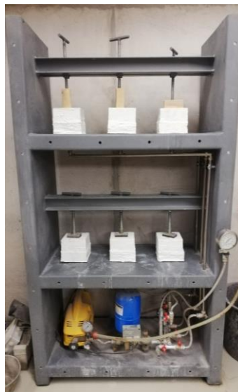
Figura 3: Estrutura do equipamento utilizado para ensaio de determinação da capacidade de impermeabilização.
