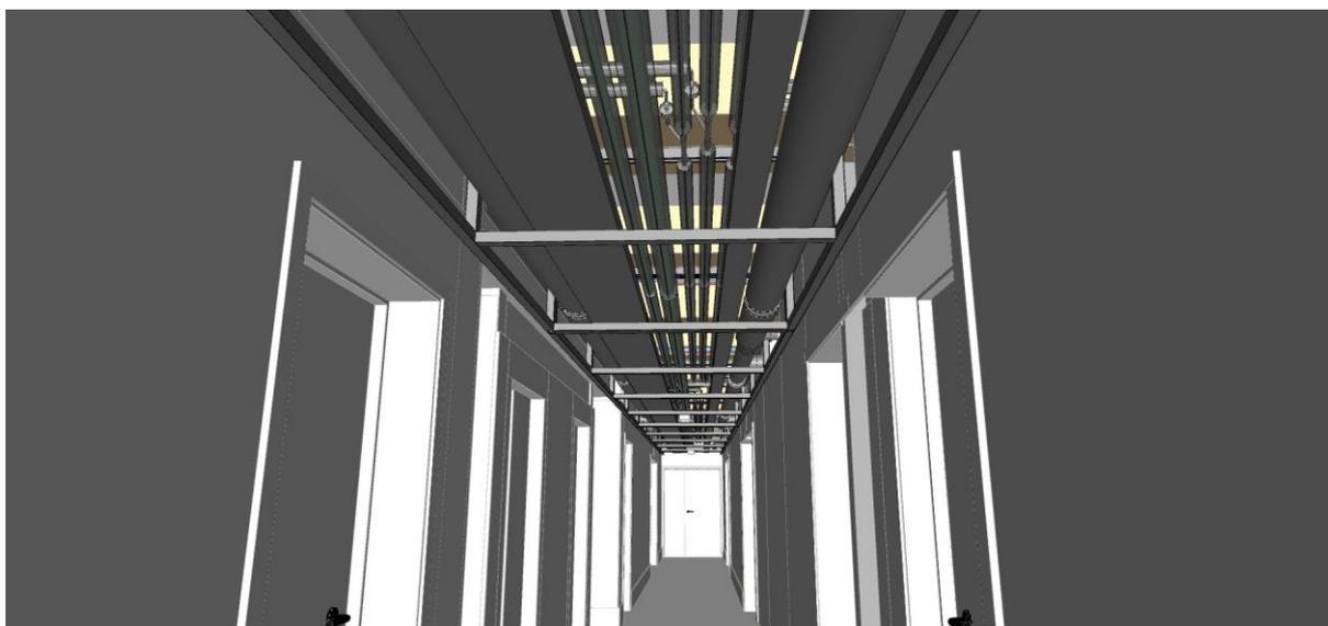
Figura 45 – Vista de um corredor dos Pisos Tipo, com a disposição dos módulos MEP horizontais.
