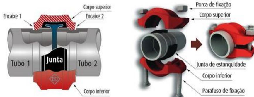
Figura 55 - Funcionamento da união ranhurada utilizada no sistema de abastecimento de água contra incêndios.
