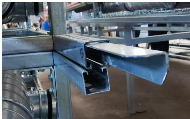
Figura 58 – Guias metálicas para garantir o alinhamento entre as estruturas de suporte dos módulos.
