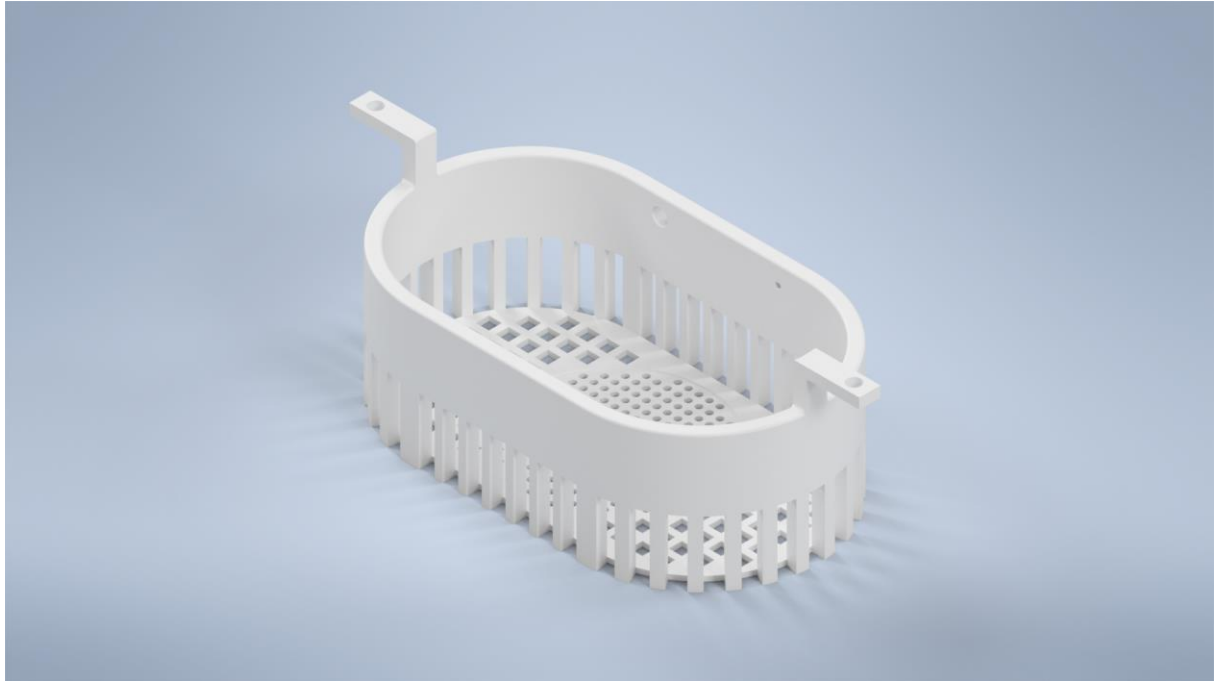
Figura 28 - Modelação do Cesto de Suporte da solução, com destaque para os furos e saliências
