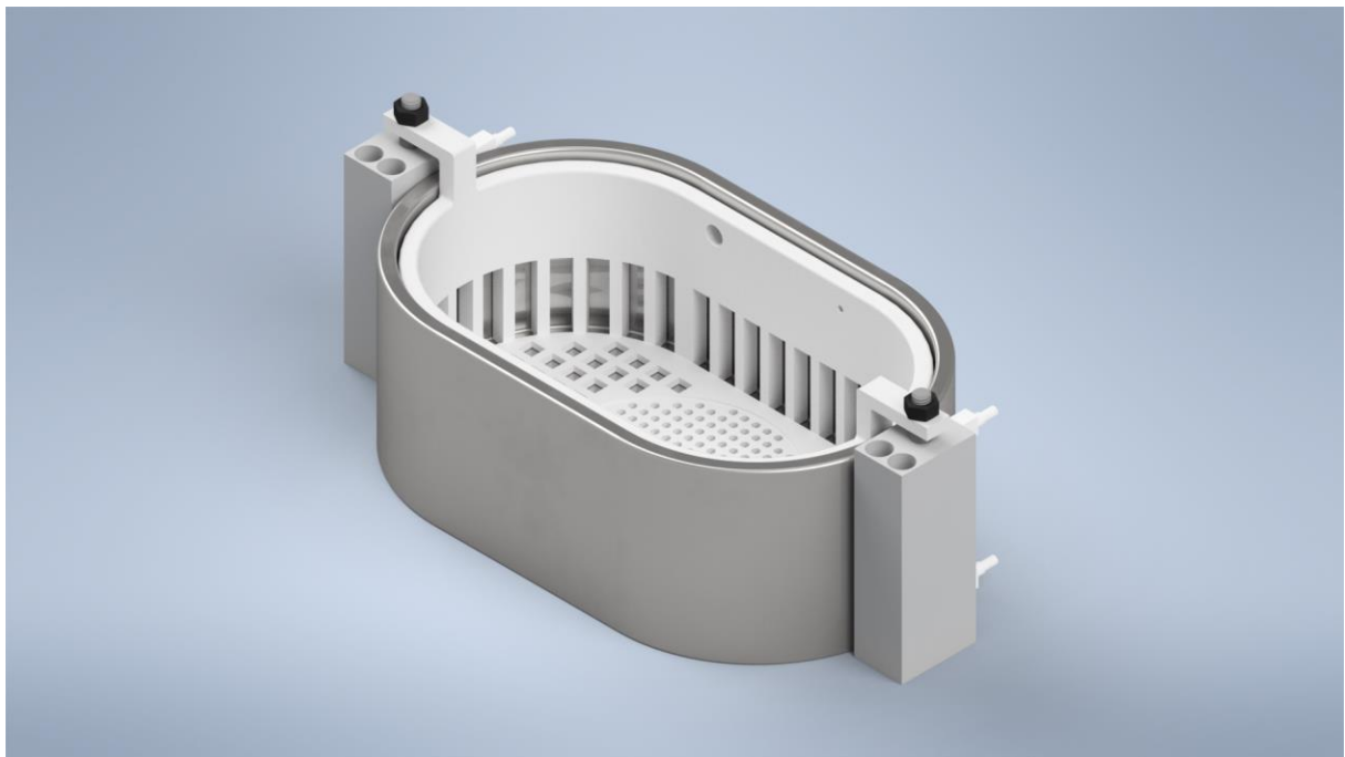
Figura 25 - Modelação do sistema de elevação do cesto
