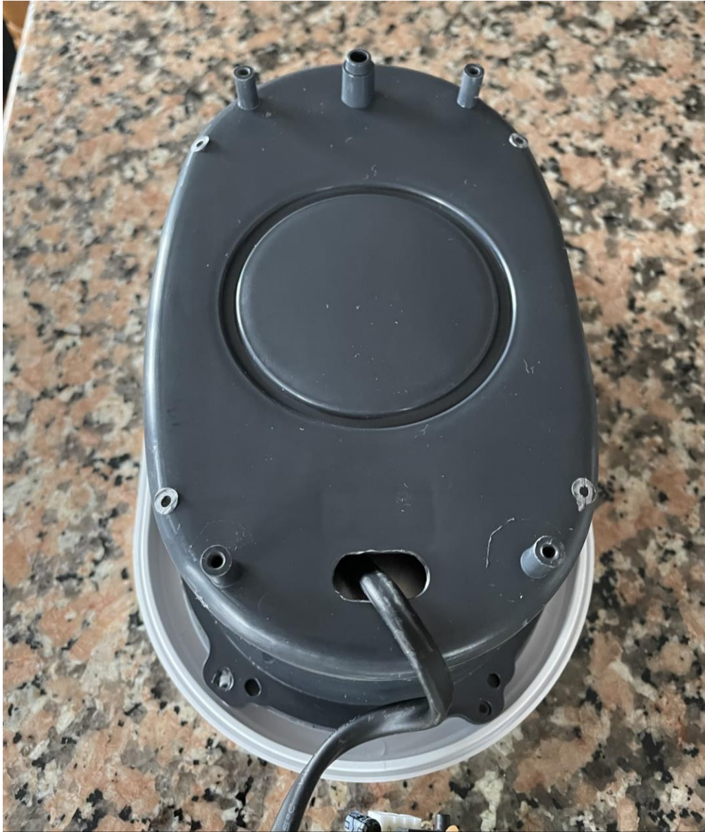
Figura 13 - Suporte do tanque do Grundig UC5620
