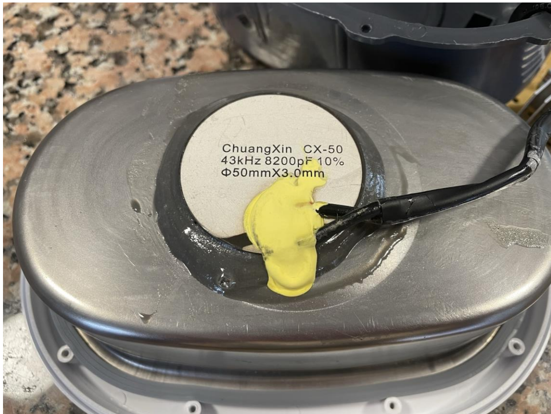
Figura 14 - Sistema de oscilação do Grundig UC5620
