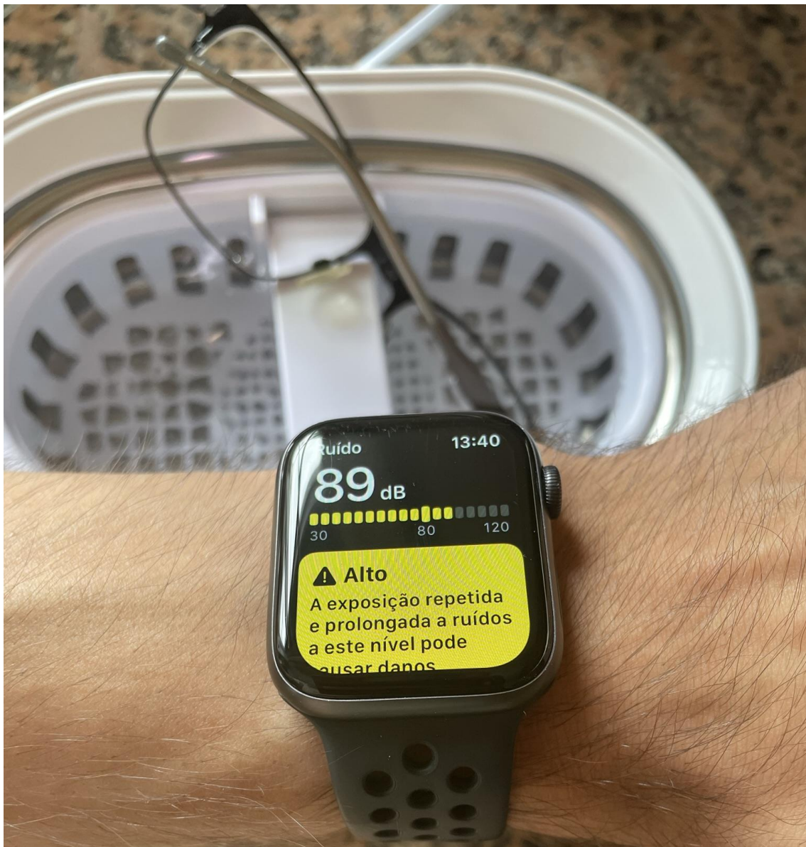
Figura 39 - Medição do Ruído do equipamento Grundig UC5620, com um Apple Watch Series 5
