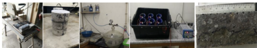
Figura 5 – Teste de penetração de cloretos
