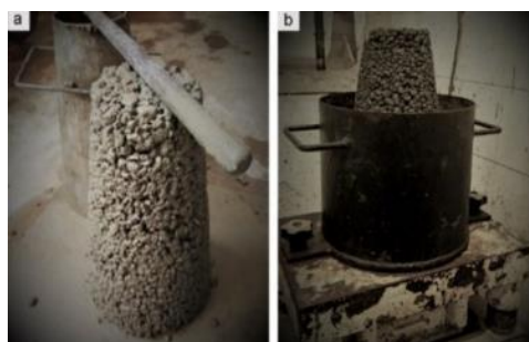
Figura 21. (a) Abaixamento e (b) ensaio de Vêbê
