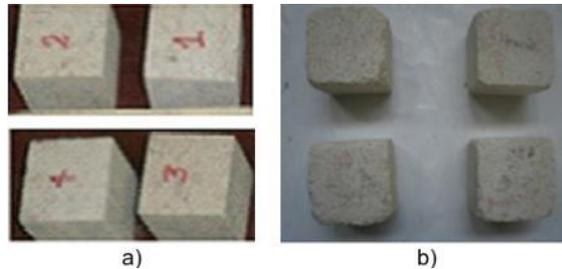
Figura 50. Resultado visual a) provete no início b) 25ºciclos por imersão de cloreto de sódio
