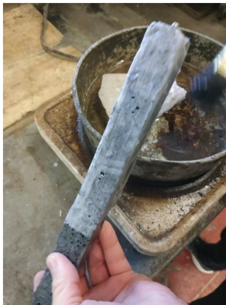
Figura 4.8 - Aplicação de parafina nas barras produzidas
