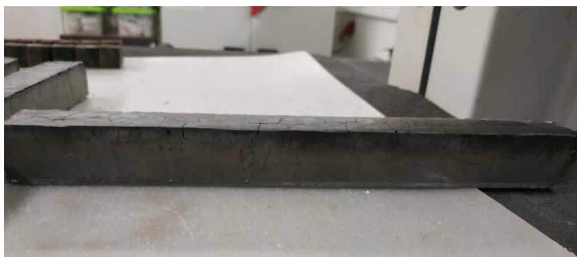
Figura 3.6 - Exemplo de uma barra com fissuração devido à retração de secagem
