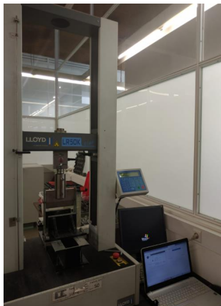
Figura 4.3 – Equipamento para ensaios mecânicos Lloyd LR50k Plus, com limite máximo de 50 kN
