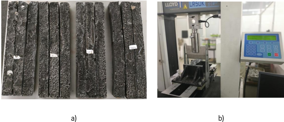
Figura 4.5 – a) Provetes submetidos ao ensaio de resistência à flexão; b) Equipamento Lloyd LR50k Plus com o devido acessório de flexão na realização do ensaio de flexão
