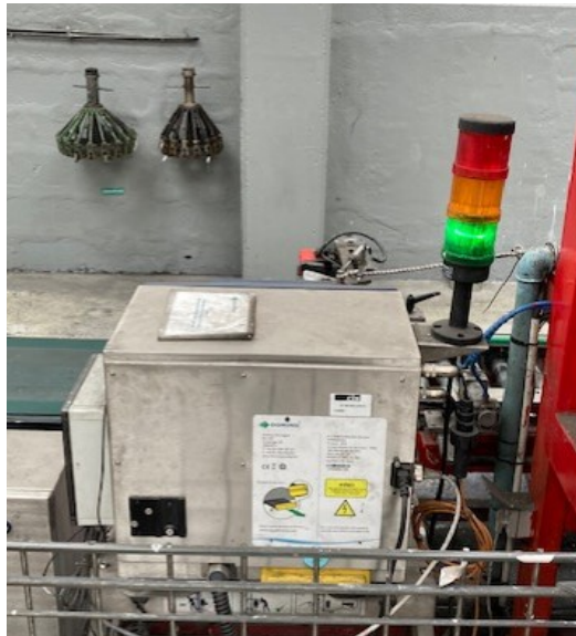
Figura 5 - Exemplo de um Andon
