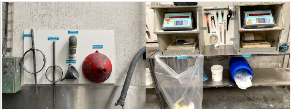
Figura 47 - Organização das ferramentas e dos materiais depois da aplicação dos 5S
