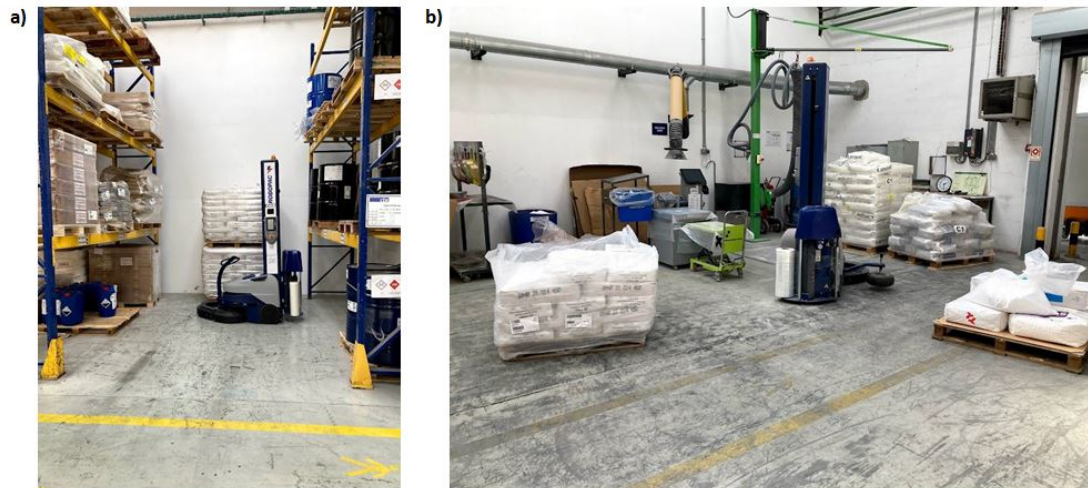
Figura 15 - Exemplo de Armazenamento incorreto do robot a) e utilização incorreta do robot b)
