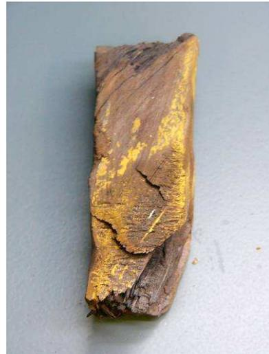
Figura 30-Eucalipto após ensaio 07bar-164.91°C
