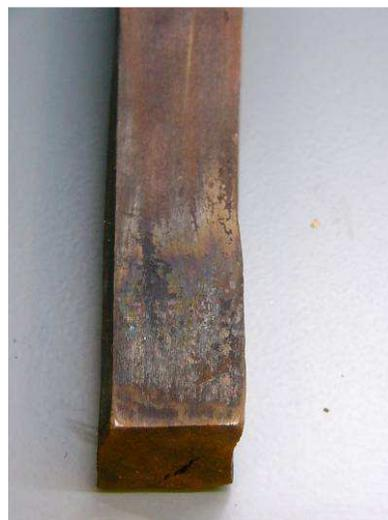
Figura 34-Eucalipto após ensaio 07bar-164.91°C
