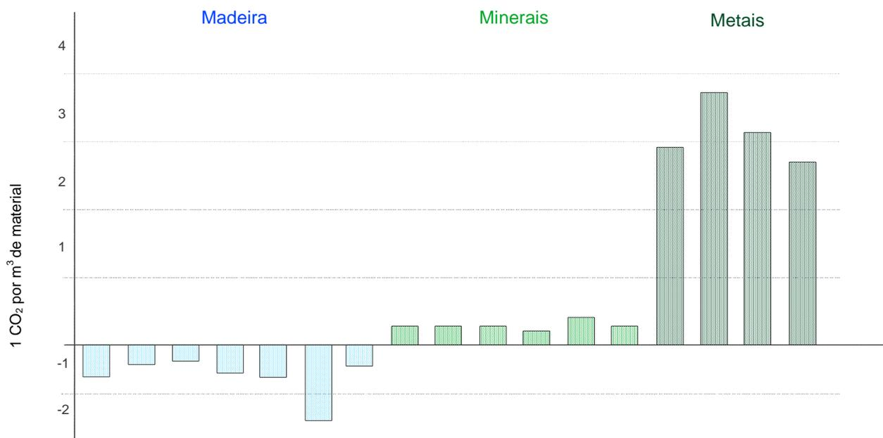
Figura 12-Emissões de CO<sub>2</sub> de alguns materiais de construção, durante o seu ciclo de vida.
