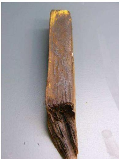
Figura 31-Eucalipto após ensaio 15bar-198.24°C
