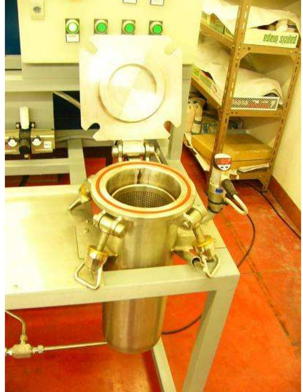
Figura 42-Camãra de pressão/vácuo do equipamento experimental
