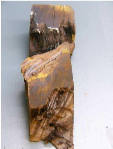
Figura 29-Eucalipto após ensaio 15bar-198.24°C
