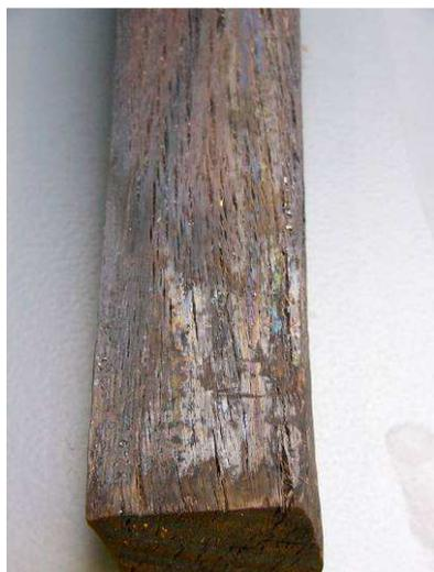
Figura 33-Eucalipto após ensaio 15bar-198.24°C
