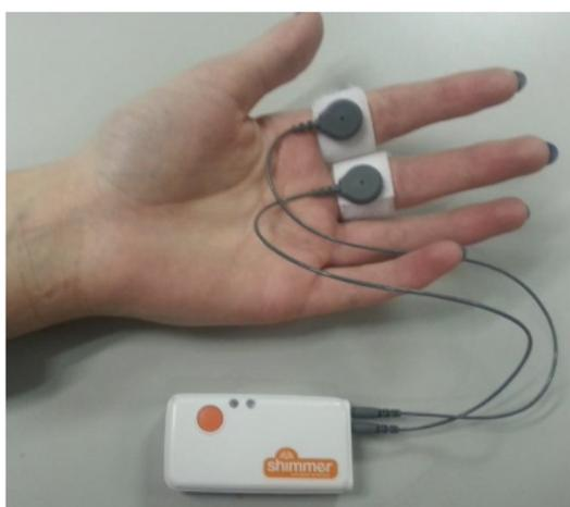
**Figura 17- Posicionamento sensore GSR**
