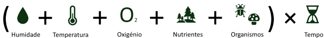
Figura 2.16 - Fatores condicionantes para a degradação biológica.
