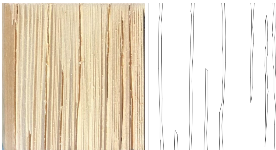
Figura 4.29 - Medição da redução da área resistente ao corte.
