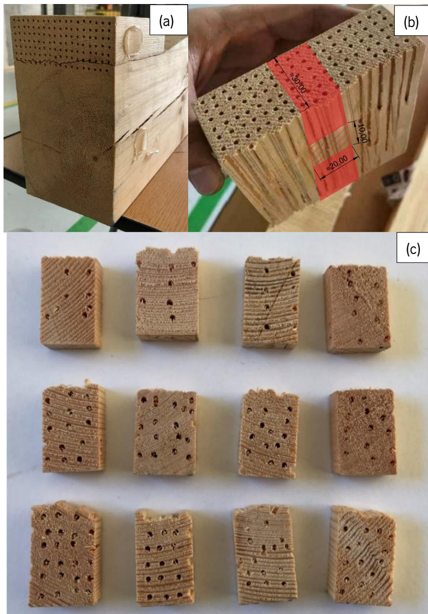
Figura 4.3 - Seleção/preparação das amostras para a \mu -XCT. (a) Talão resultante do ensaio à compressão (rotura por corte paralelo às fibras do talão); (b) Local de retirada da amostra no talão; (c) Amostras extraídas do centro do talão.
