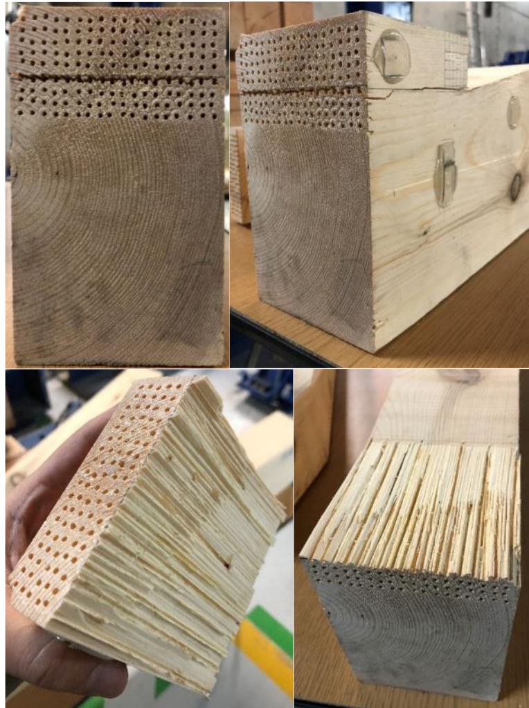
Figura 4.15 - Linha com rotura por corte paralelo às fibras após o ensaio a compressão.
