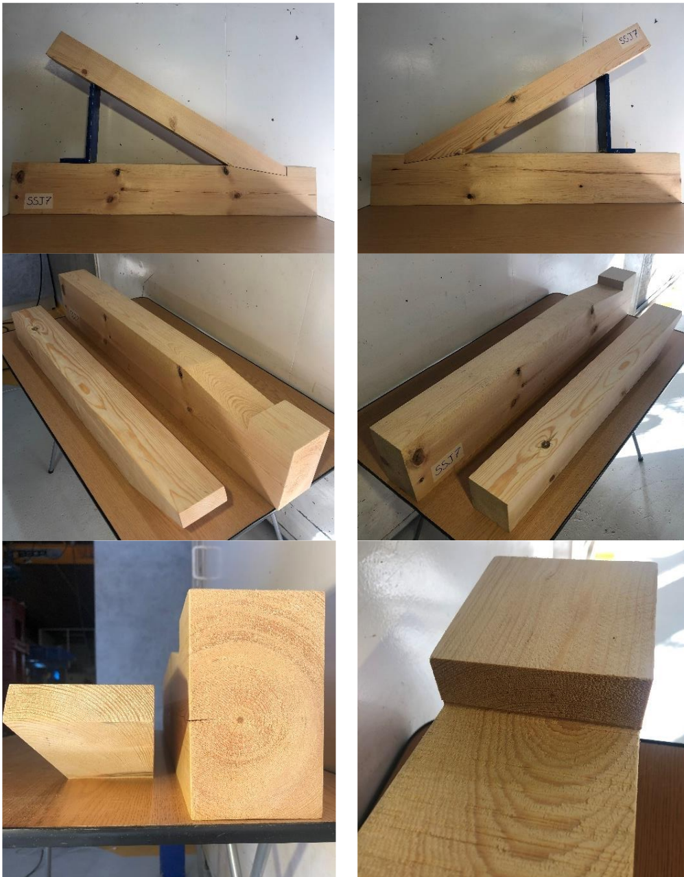
Figura 3.5 - Levantamento fotográfico de um dos provetes de ligação Perna-Linha.
