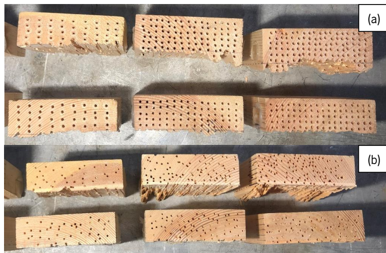
Figura 4.10 - Simulação da degradação por caruncho. (a) Furos de entrada; (b) Furos de saída.
