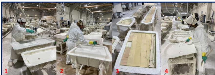
Figura 22- Laminação: Projeção de resina e fibra de vidro (1), Skin (2), Colagem (3) e Stiffen (4)
