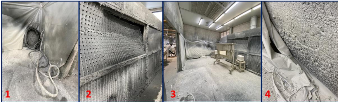
Figura 38- Mangueira para pintar (1), filtros de aspiração (2), cabine de pintura (3), parede da cabine (4)
