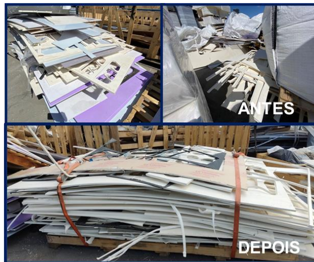
Figura 71- Plástico HDPE armazenado para aterro e plástico HDPE pronto para transporte para valorização
