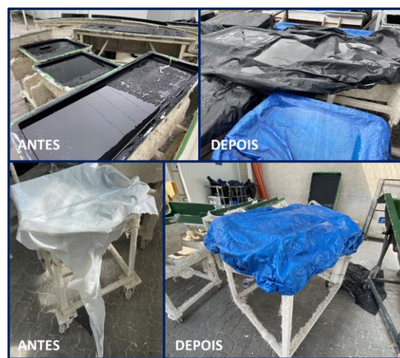
Figura 70- Proteção dos moldes antes e depois da utilização das lonas
