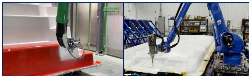
Figura 67- Braço mecânico para pintura (imagem da esquerda) e braço mecânico para corte (imagem da direita)
