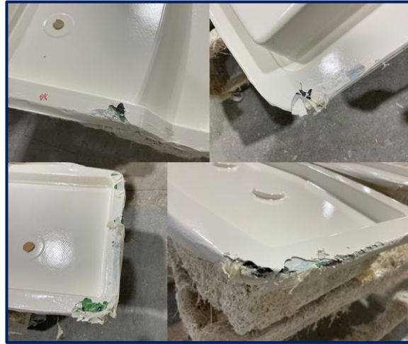
Figura 32- Defeitos com choque dos carrinhos
