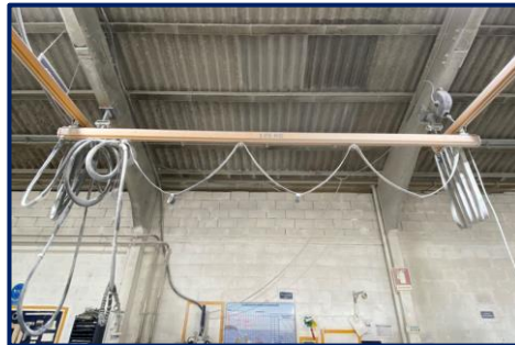
Figura 65- Suporte para mangueira de projeção na zona do stiffen
