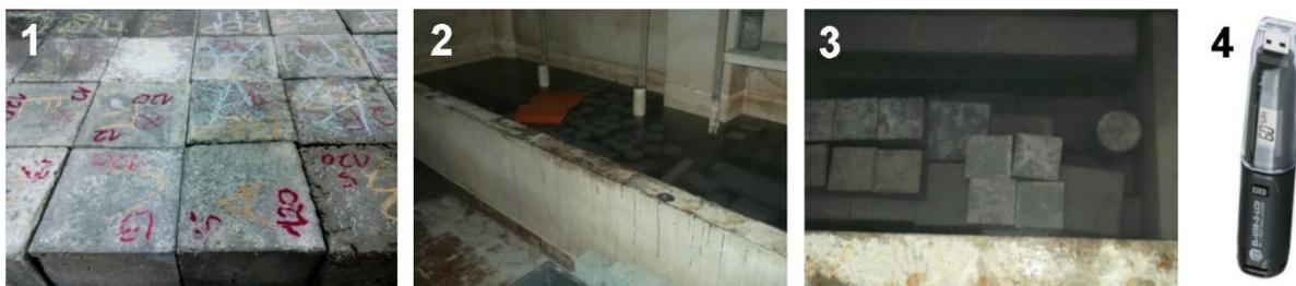
Figura 6.5 - Etapas do estudo da amassadura padrão: provetes após desmoldagem (1), cura na câmara húmida (2)(3) e *data logger* (4)
