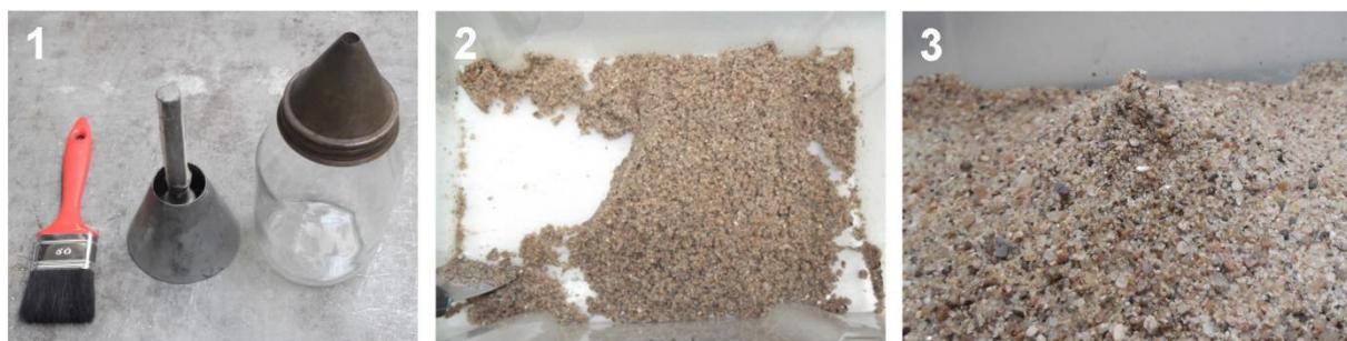
Figura 4.3 - Ensaio de massa volúmica das partículas e absorção de água da areia: equipamento (1), secagem (2) e condição final (3)
