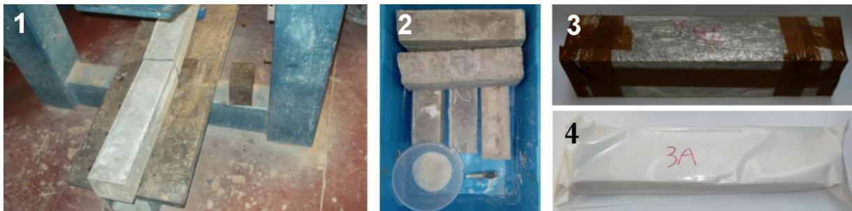
Figura 7.3 - Ensaio de acondicionamento: seccionamento das vigas (1), câmara de acondicionamento (2) e selagem dos provetes (3)(4)
