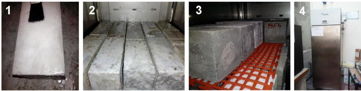
Figura 7.4 - Ensaio de carbonatação acelerada: aplicação de parafina (1), interior da câmara climática (2)(3) e câmara climática (4)
