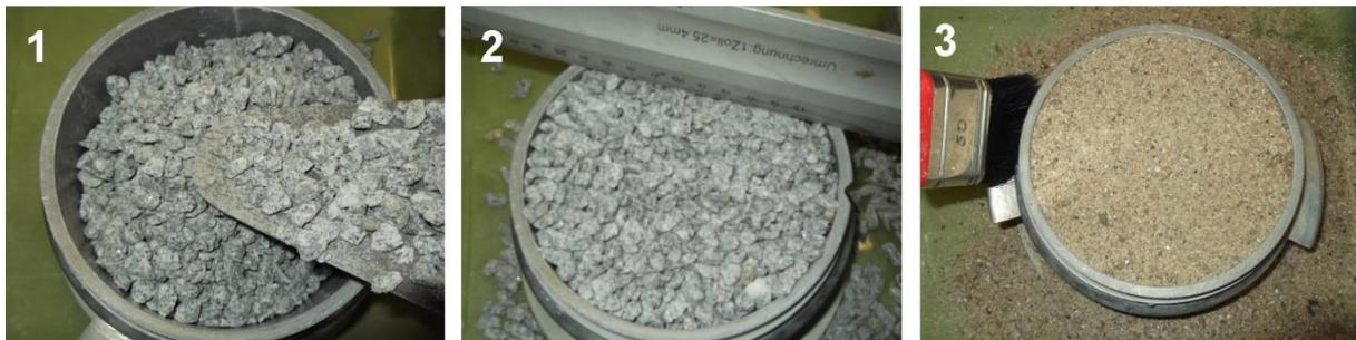
Figura 4.4 - Ensaio de baridade e de volume de vazio: enchimento (1), nivelamento (2) e resultado (3)
