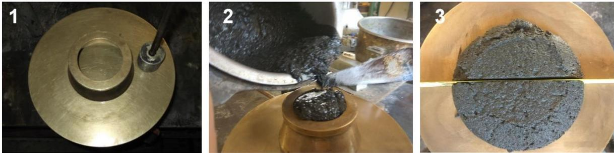
Figura 5.3 - Ensaio de espalhamento das argamassas: equipamento (1), execução (2) e resultado (3)
