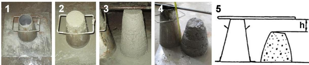
Figura 6.7 - Ensaio de abaixamento: preparação (1), enchimento (2), resultados (3)(4) e critério de medição
