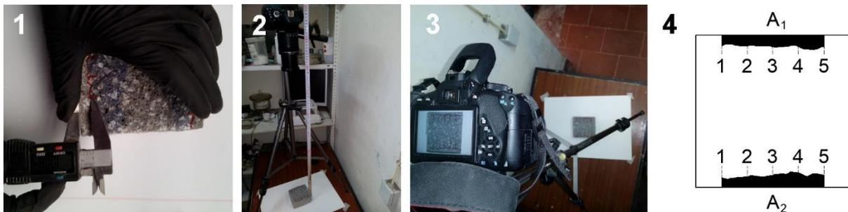
Figura 7.5 - Ensaio de carbonatação acelerada: medição *In situ* (1), levantamento fotográfico (2)(3) e medição em *CAD* (4)
