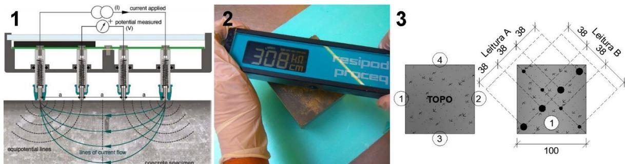
Figura 6.9 - Ensaio de resistividade elétrica: princípio de funcionamento (1), leitura sobre um provete (2); localização das leituras (3)
