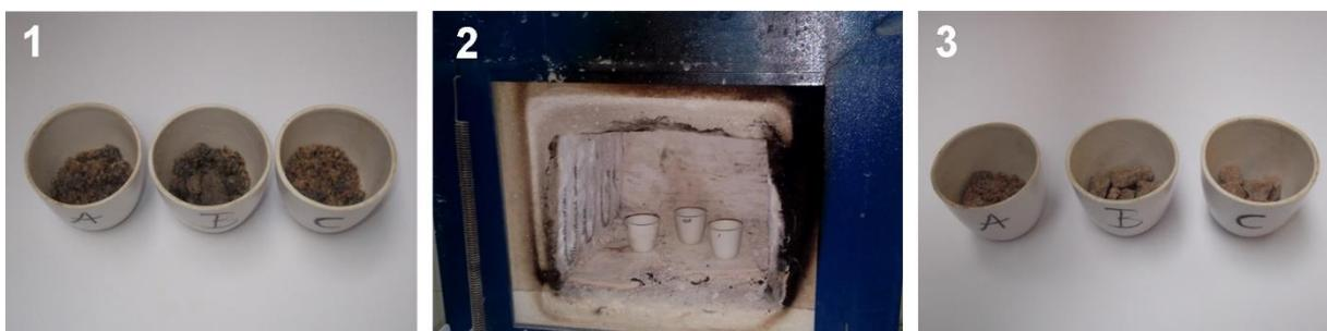
Figura 6.3 - Sequência do procedimento para o ensaio de determinação do teor de humidade dos agregados: mufla (1), provetes antes (2) e depois (3) do aquecimento
