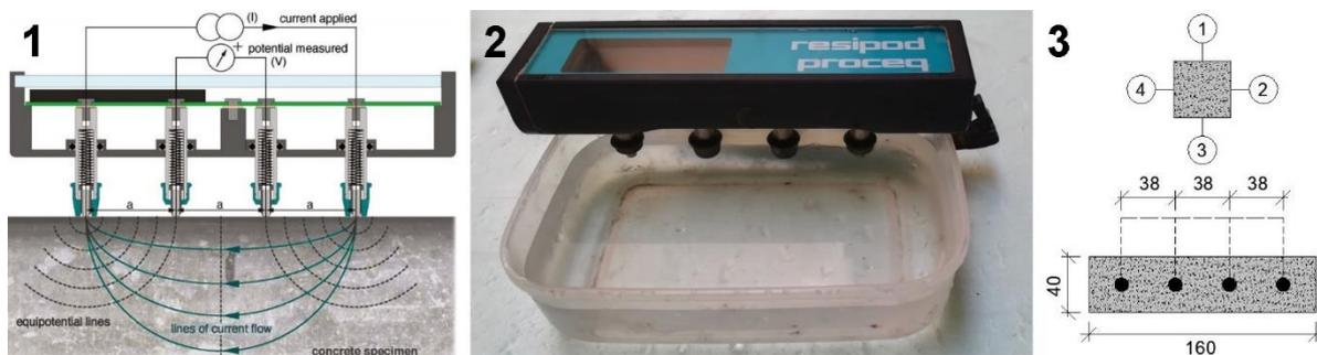
Figura 5.4 - Ensaio de resistividade elétrica das argamassas: princípio de funcionamento (1), equipamento (2) e leituras (3)
