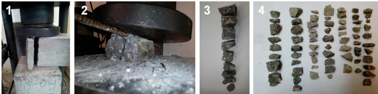
Figura 7.7 - Ensaio de teor de água do betão: fatiamento inicial (1), divisão em partes menores (2) e resultado final (3)(4)
