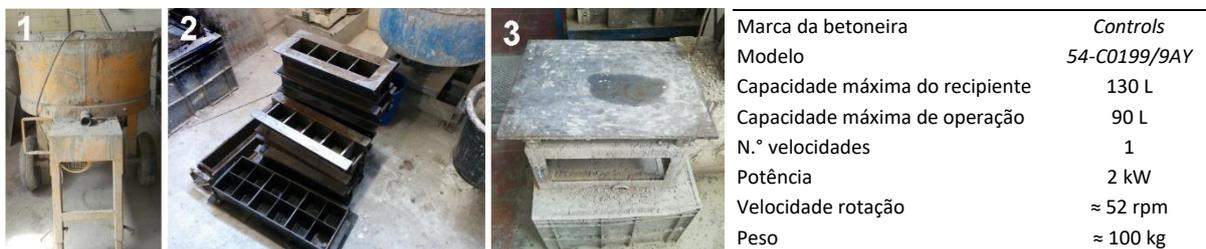
Figura 6.2 - Sequência do processo da amassadura padrão: betoneira (1), moldes (2), mesa vibratória (3) (esq) e características da betoneira (dir)
