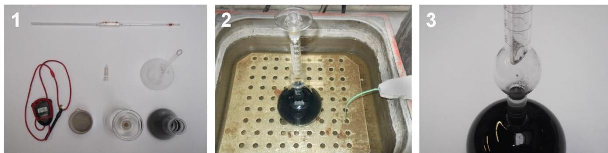
Figura 4.10 - Ensaio da massa volúmica das cinzas volantes: preparação (1); banho-maria (2) e introdução das cinzas volantes (3)
