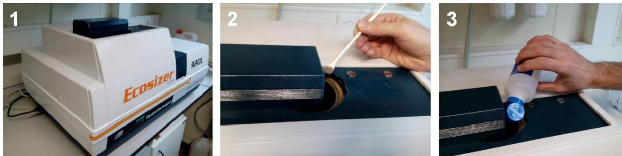
Figura 4.5 - Ensaio de granulometria laser: equipamento (1), colocação da amostra (2) e calibração (3)
