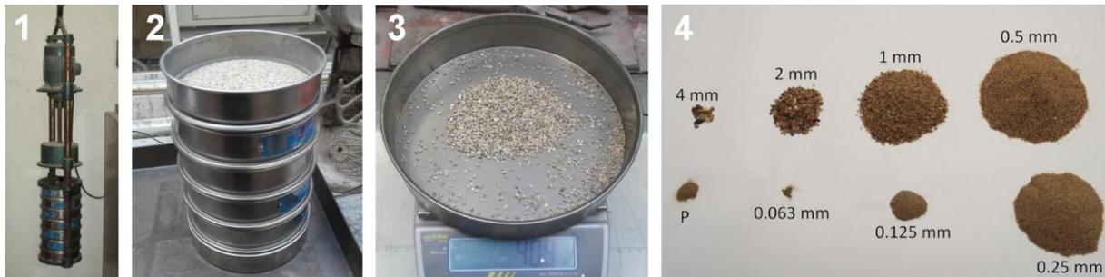
Figura 4.1 - Ensaio granulométrico da areia: coluna de peneiros (1)(2), pesagem (3) e resultado (4)
