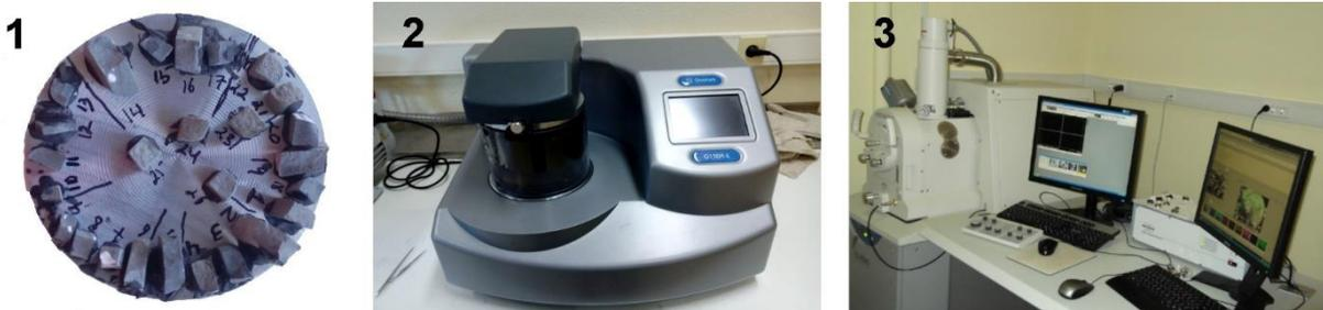
Figura 7.13 - Ensaio de *MEV* em pastas: colocação e identificação das amostras no porta-amostras (1), depositador de carbono (2) e *setup* do equipamento (3)
