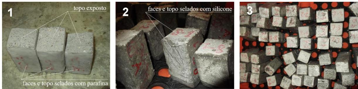
Figura 5.8 - Ensaio de absorção de água por capilaridade das argamassas: critérios da selagem (1)(2) e vista geral (1)
