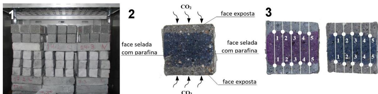
Figura 5.6 - Ensaio de carbonatação acelerada das argamassas: interior da câmara (1), critérios de exposição (2) e de medição (3)
