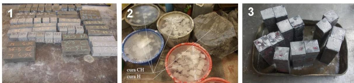
Figura 5.2 - Ensaio em argamassas: desmoldagem (1), cura (2) e provetes após a *cura CH* (3)
