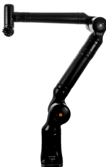
Figura 30 - Robô colaborativo Kassow KR1805
