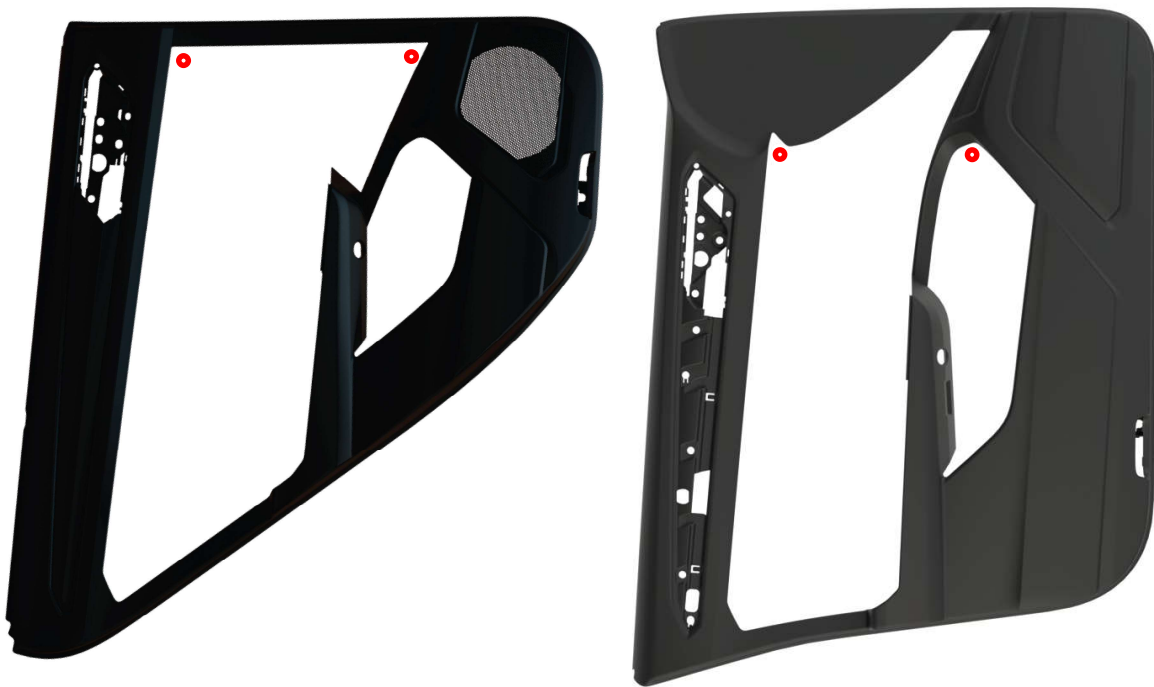
Figura 55 - Localização dos pontos para os pinos de paletização da estante
