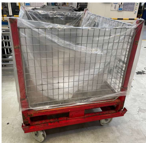
Figura 19 - Contentor para peças incompletas e peças não validadas
