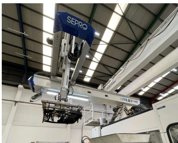
Figura 16 - Robô cartesiano utilizado na Simoldes Plásticos
