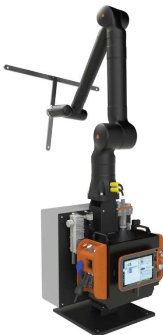
Figura 51 - Modelação do robô com controlador, componentes pneumáticos e quadro elétrico
