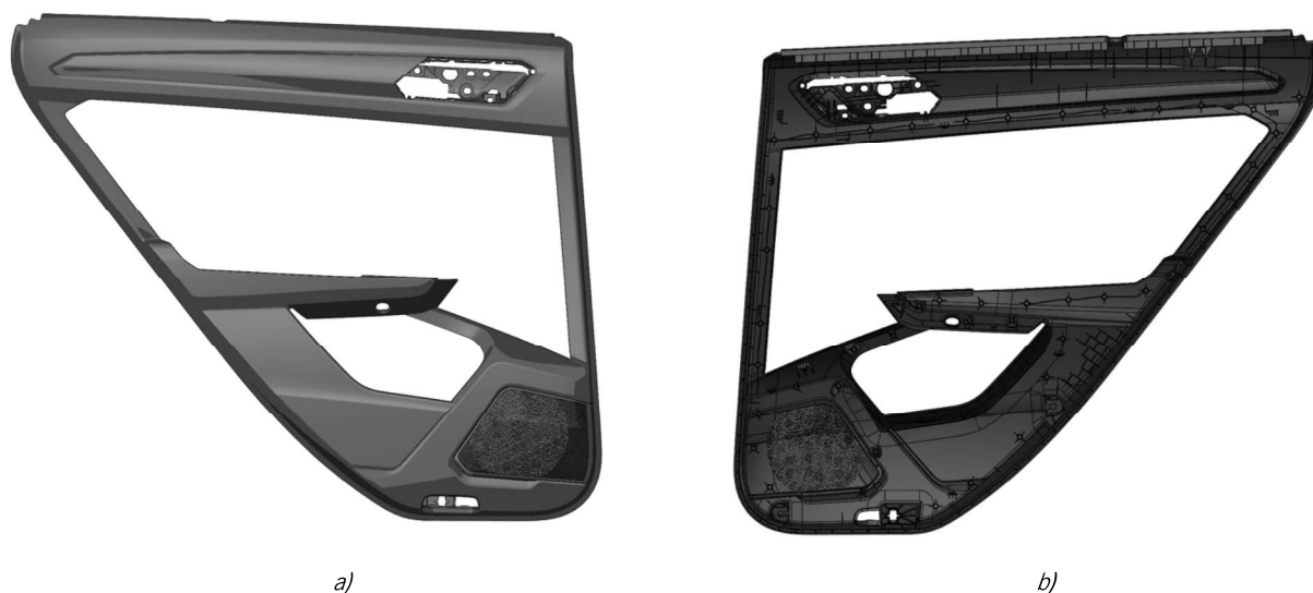
Figura 40 - Painel de porta traseiro: a) lado visível b) lado técnico
