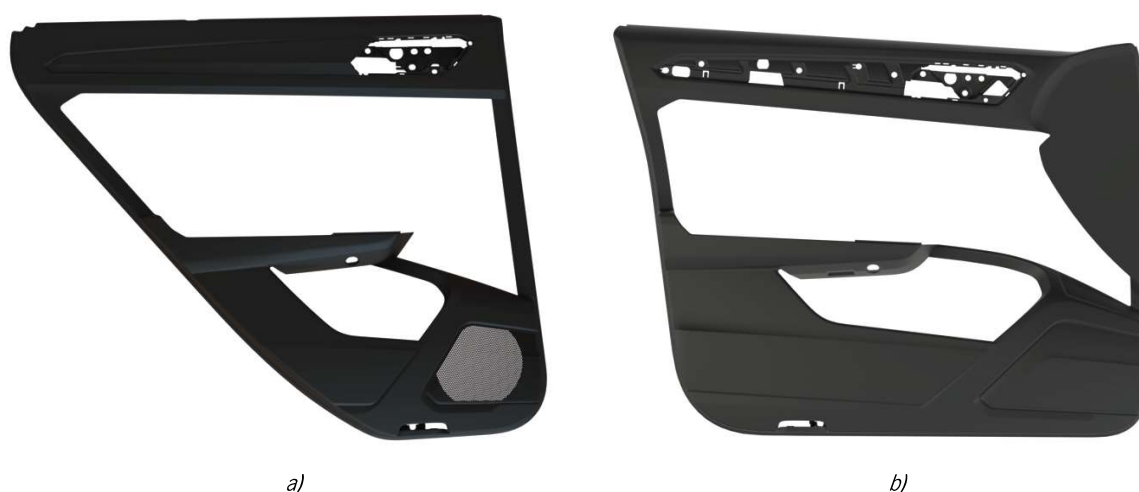
Figura 14 - a) Modelação CAD do painel de porta traseiro esquerdo b) Modelação CAD do painel de porta dianteiro esquerdo
