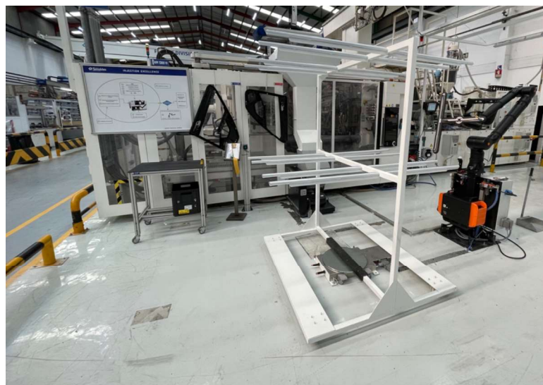
Figura 81 - Colocação do primeiro robô e estante com sistema de rotação
