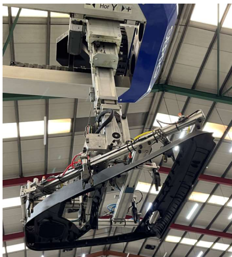
Figura 39 - Manipulador com ventosas de sucção do robô cartesiano
