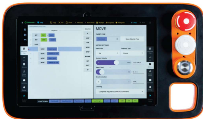
Figura 32 - Interface de ecrã tátil para programação do braço robótico
