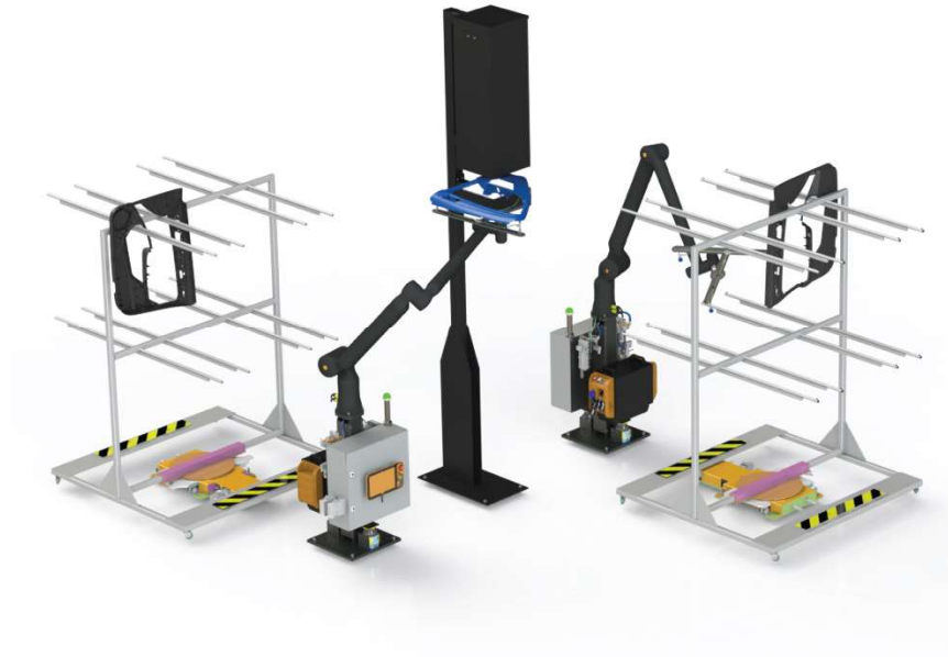
Figura 69 - Funcionamento de dois robôs de máquinas distintas com apenas uma câmara de análise
