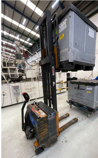
Figura 23 - Elevador para empilhamento de contentores.
