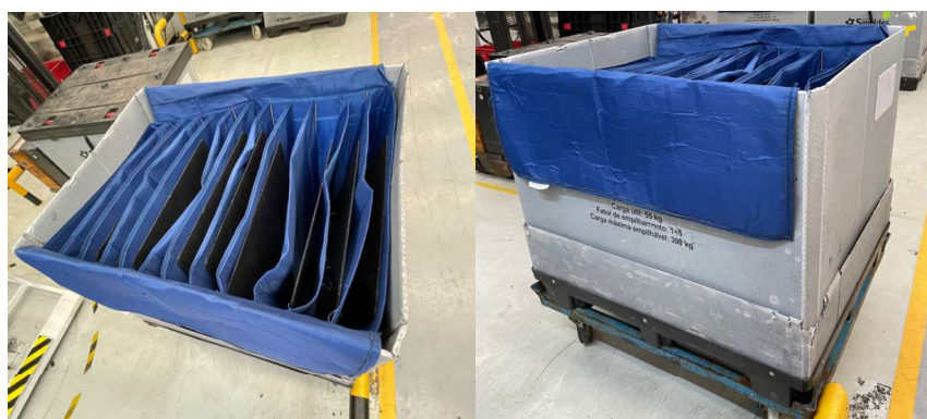
Figura 22 - Contentor com alvéolos para armazenamento e transporte dos painéis de porta
