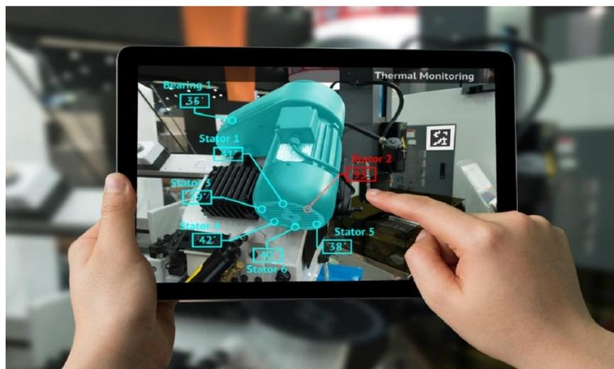
*Figura 9 - Operação diagnóstica do equipamento, através de marcadores, com acesso às temperaturas dos vários componentes*
