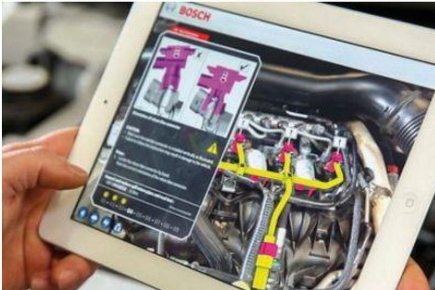
*Figura 8 - Operação de reparação com acesso a instruções passo-a-passo, a imagens, descrições e localização do equipamento defeituoso através de um modelo virtual.*
