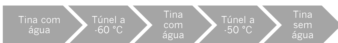
Figura 8 - Processo de vidragem para a análise do red-fish .
