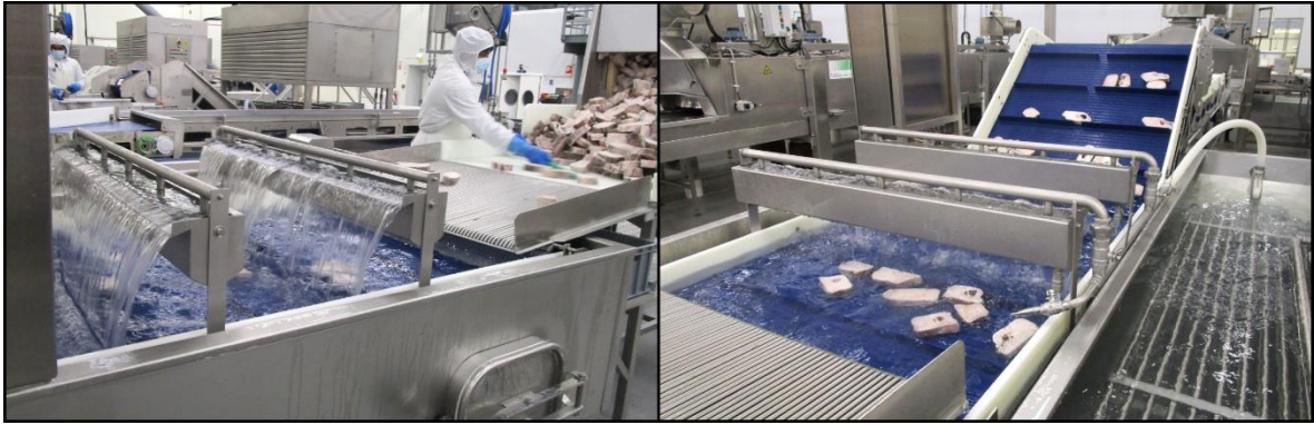
Figura 2 - Vidragem de pescado usando os métodos de imersão e pulverização simultaneamente, de forma mecânica.
