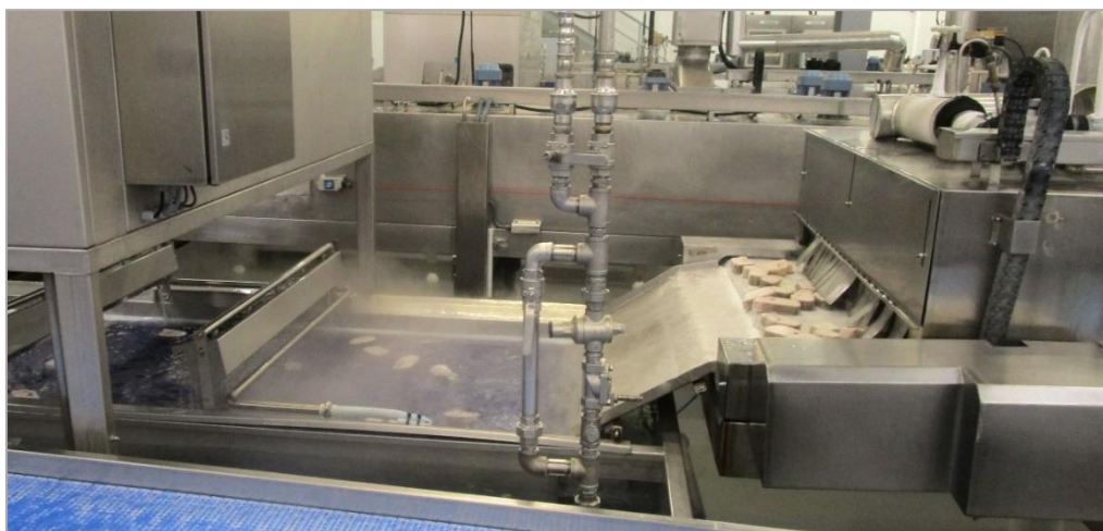
Figura 3 - Túnel de congelação criogénica em funcionamento.
