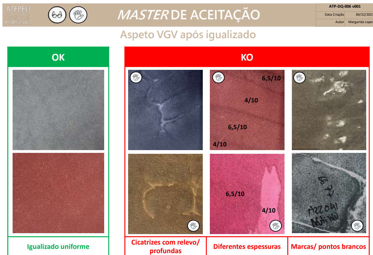
Figura 31 – Master de Aceitação para a pele VGV após o processo de igualizar.
