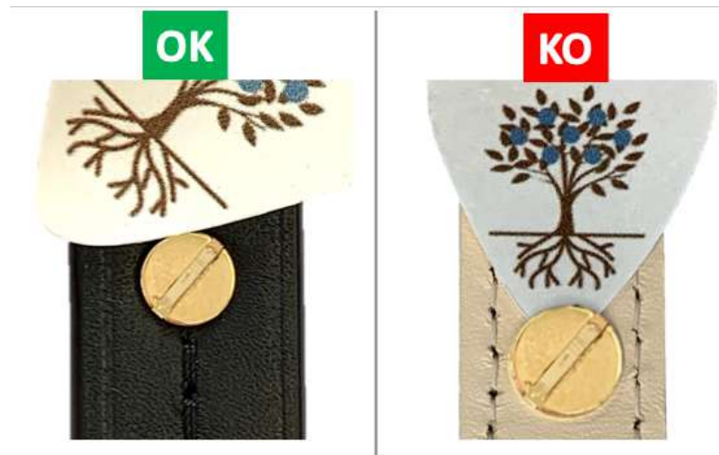
Figura 9 – Imagens de um médiator - numa cravação OK e numa cravação KO.
