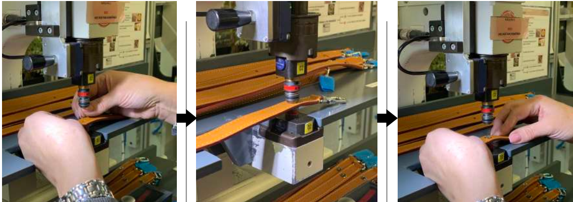
Figura 13 – Exemplo de um processo de cravação numa máquina automática – primeiro coloca-se o componente na matriz de cravação, depois inicia-se o processo de cravação da peça metálica e, por fim, o artesão retira o componente da máquina.
