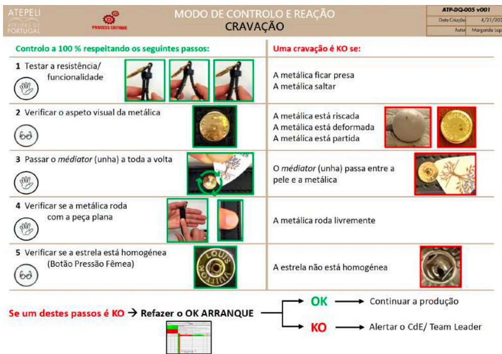
Figura 21 – Novo modo de controlo da cravação.
