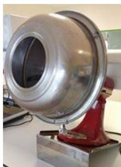
**Figura 4.** Bombo de gragear utilizado a nível laboratorial.
