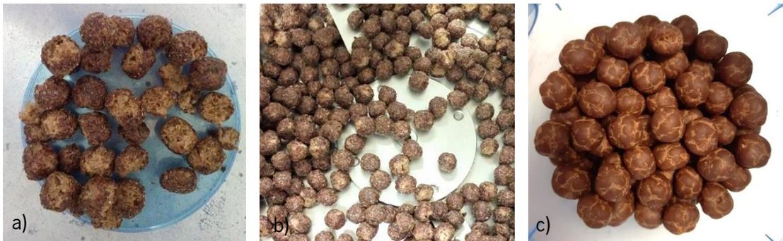
**Figura 13.** Ilustrações do desperdício de cereais 2 revestidos apenas com goma laca (a), dos componentes com quebras na sua superfície (b), e dos aglomerados de solução de revestimento formados na superfície dos cereais (c).
