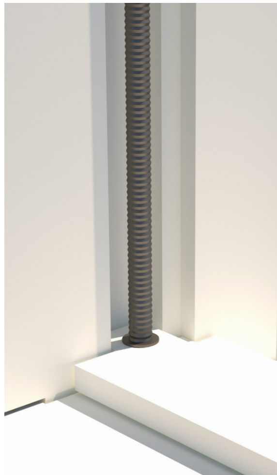
F.12. Detalhe União entre o Fuso e a Porca
