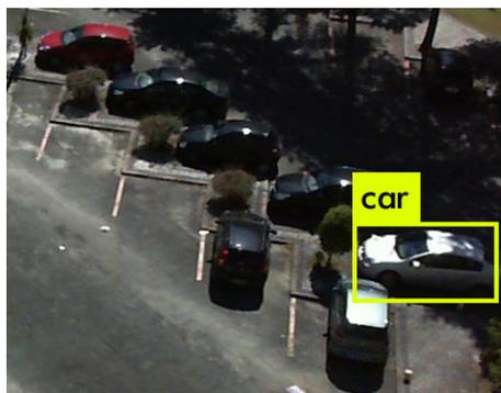
Figura 32: Problema na detecção de veículos devido à iluminação
