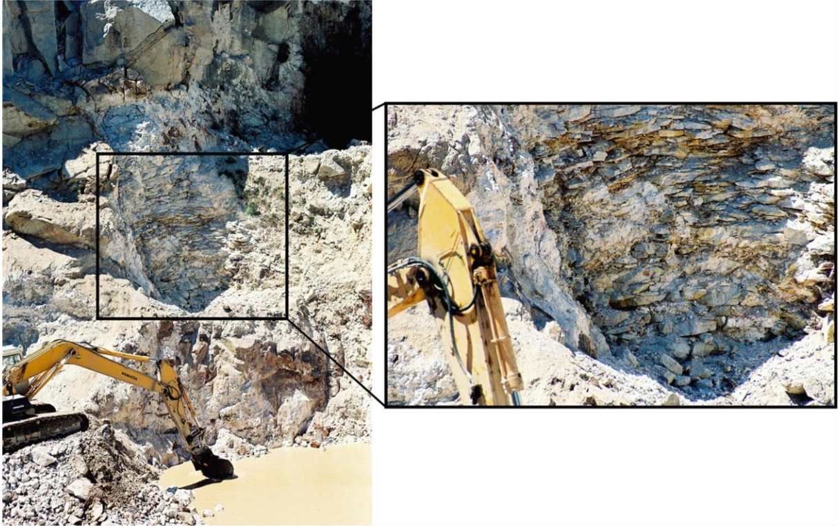
Figura 9 – Imagens da frente de desmorte NW do corpo Sul do Grupo Pegmatítico de Senhora de Assunção, Sátão, ilustrando um “pipe” de brecha de colapso com alteração hidrotermal – padrão estrutural muito distinto daquele que indicia fracturação hidráulica. Corta Sul no grupo pegmatítico de S.ª de Assunção, Sátão – “sinkhole” de colapso gravítico por esvaziamento – com brecha de clastos horizontalmente alongados (essencialmente quartzosos) e matriz de caulinite + haloizite + mica e relíquias de columbite-tantalite + zircão (após caulinização dos feldspatos).
