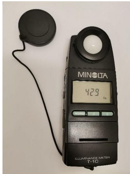
Figura 23. Luxímetro utilizado na medição da iluminância com os diferentes comprimentos de onda.
