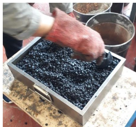
Preparação para compactação
