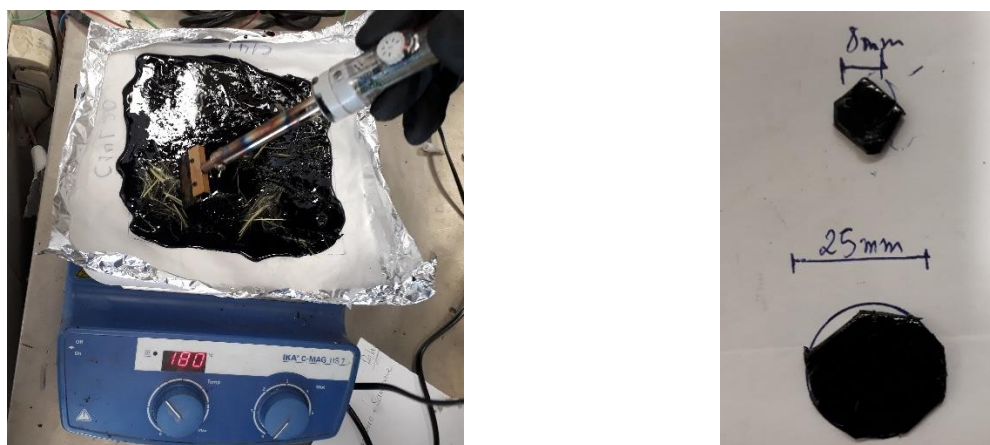
Figura 3.3 - Processo de produção de provete de betume modificado
