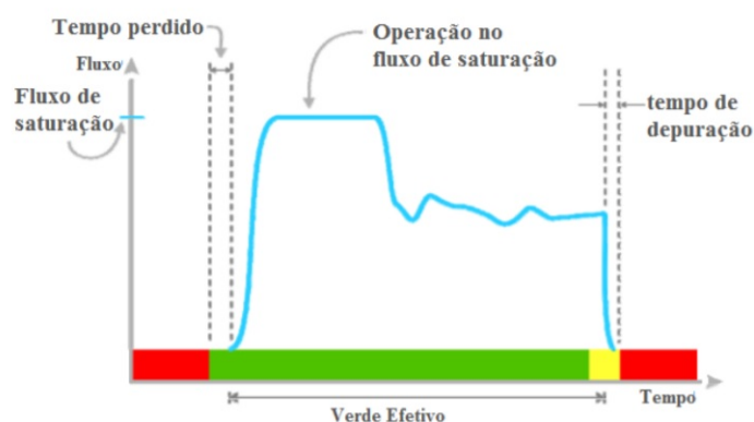
Figura 11: Gráfico do Fluxo de Saturação (figura adaptada de [36]).
