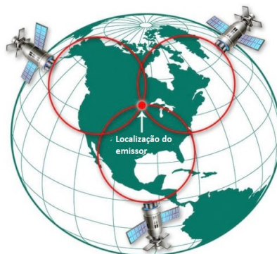
Figura 2: Representação do método da Triangulação (figura adaptada de [34]).
