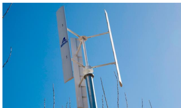
Figura 1. Exemplo de uma turbina eólica de eixo vertical (TEEV). Fonte: [12].
