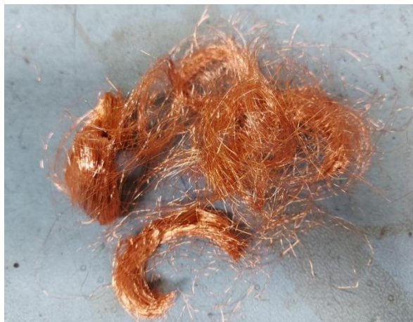
Figura 39 - Cobre resultante do desmantelamento de um aquecedor termoventilador.
