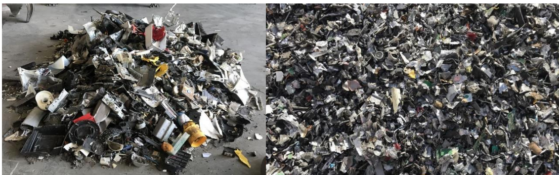
Figura 72 - REEE após pré-trituração na RSX 1200 (à esquerda) e após trituração na BDR 1645 com um tamanho de 40 mm (à direita).
