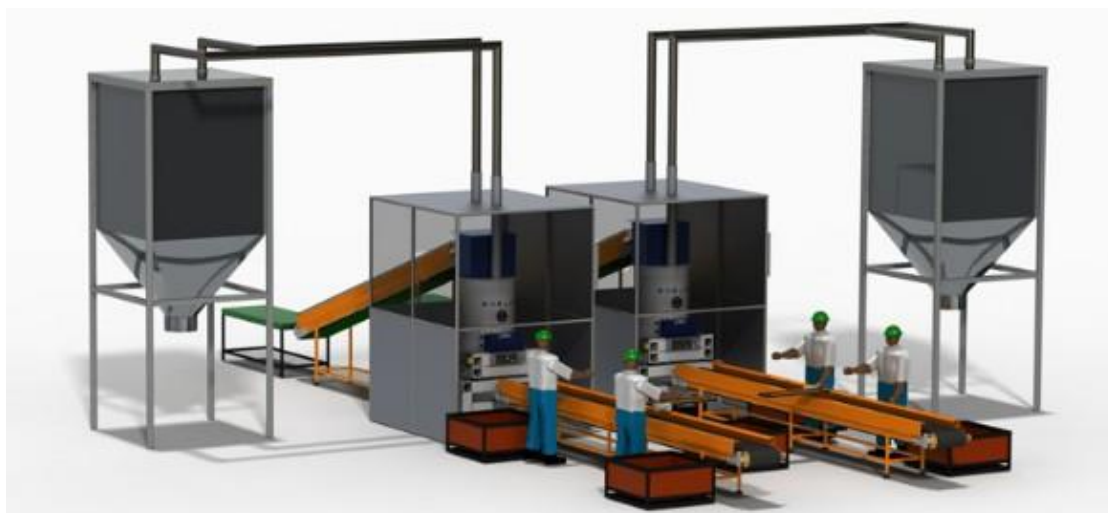
Figura 81 - Linha do MCM-S dupla com aspiradores e triagem manual pós desmantelamento.
