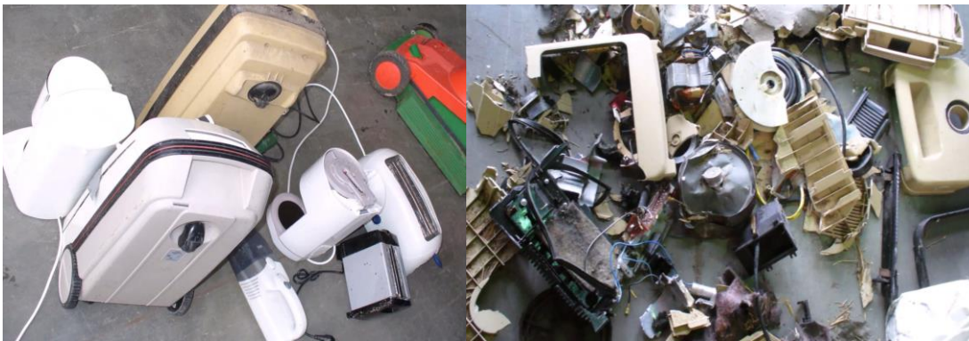
Figura 85 - REEE da categoria 5 antes (esquerda) e depois (direita) do desmantelamento mecânico no EWD 12.
