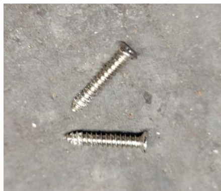
Figura 49 - Sucata ligeira, metal ferroso, resultante do desmantelamento de um router.
