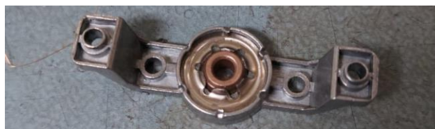
Figura 37 - Alumínio, metal não ferroso, resultante do desmantelamento de um aquecedor termoventilador.
