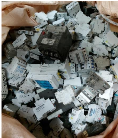
Figura 65 - Disjuntores obtidos do desmantelamento dos REEE referentes às categorias 4, 5 e 6.
