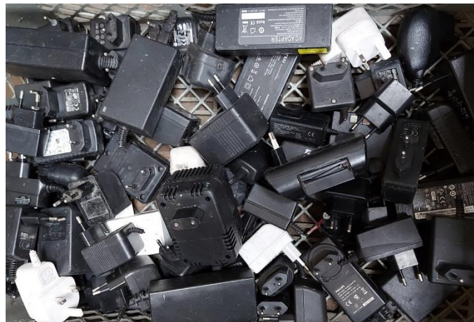
Figura 68 - Transformadores obtidos do desmantelamento dos REEE referentes às categorias 4, 5 e 6.
