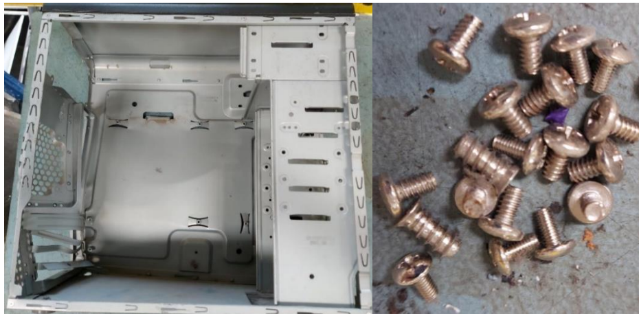
Figura 60 - Sucata ligeira, metal ferroso, resultante do desmantelamento de uma torre de computador.
