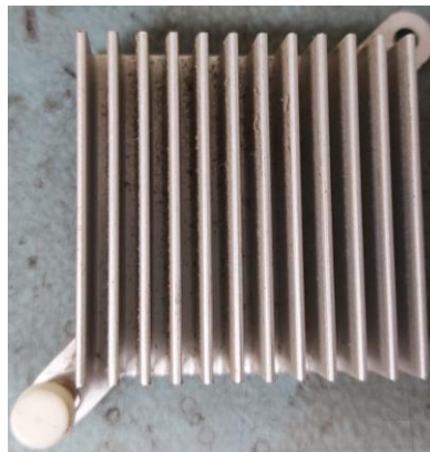
Figura 57 - Alumínio, metal não ferroso, resultante do desmantelamento de uma torre de computador.
