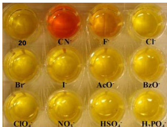
Figura 19. Alterações de cor do composto 20 , em ACN/H 2 O (9:1), observadas na presença de 100 equivalentes de diversos aniões (Figura adaptada da referência 30).
