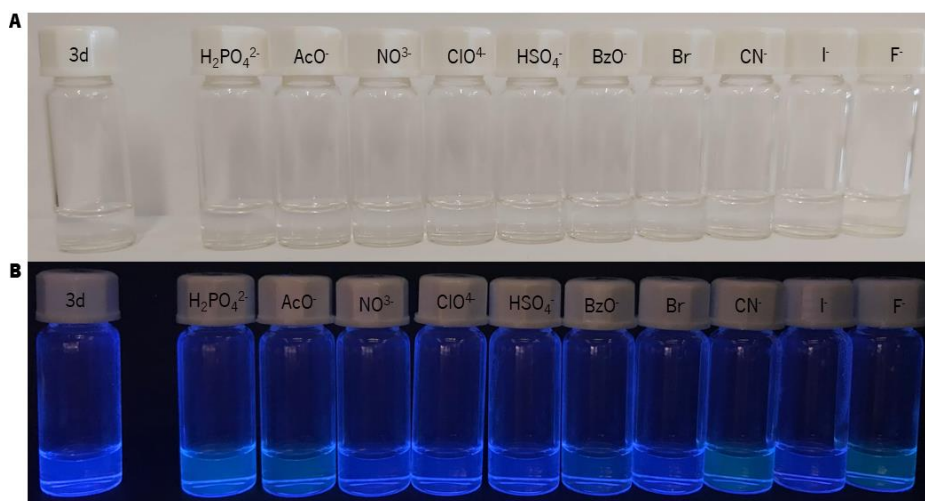
Figura 30. Soluções com o composto 3d , em ACN, depois da adição de 50 equivalentes dos aniões, (A) na presença de luz natural e (B) sob radiação UV a 365 nm.
