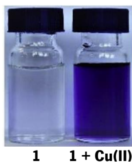
Figura 9. Solução do imidazole 1 , em H 2 O (pH 7,4)/ACN (90:10), e após a adição de Cu(II). 31
