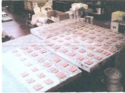
Figura 4 – Lajes de betão com colagens terminadas.
