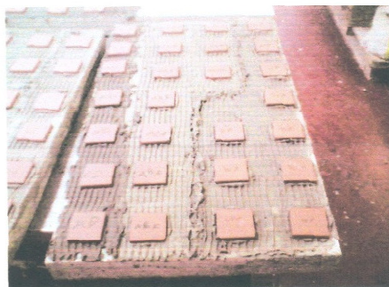
Figura 3 – Laje de betão com ladrilhos colados.
